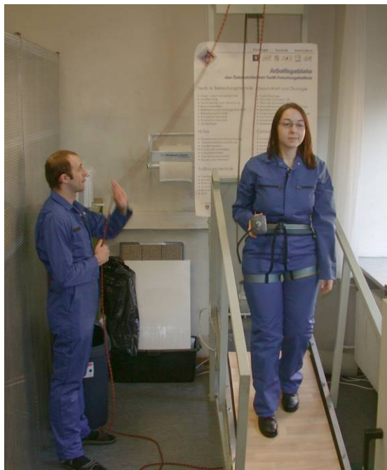
Abb. 5: Messung der Begehtspannung nach EN 1815 im Klimaraum (25°C, 50% r.f.).
