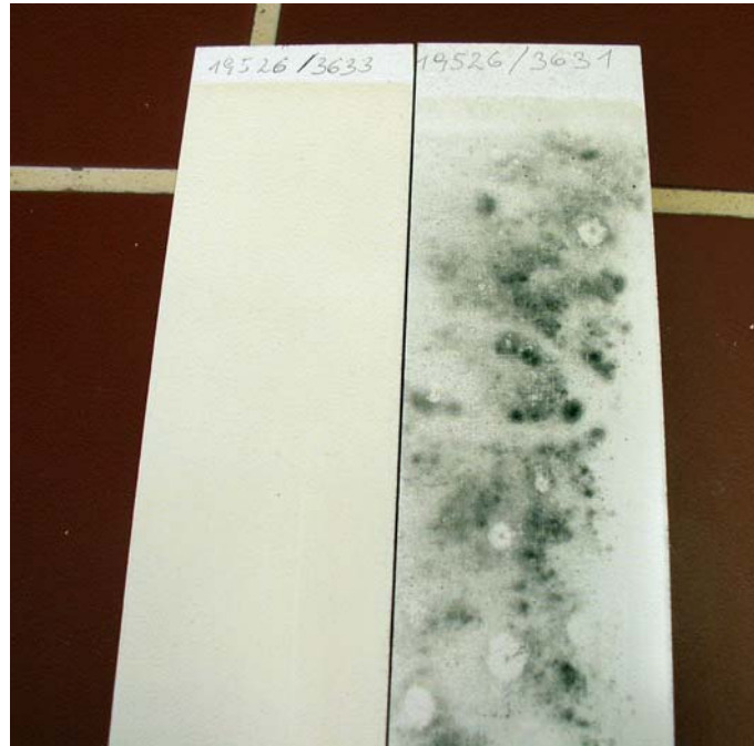
Abbildung 7: Staubtest mit Aktivkohle: links antistatische Fläche, rechts Nullprobe
