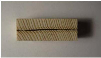
Abbildung 1: Holzschweißfuge, hergestellt nach dem Verfahren des stoffreinen Holzschweißens
