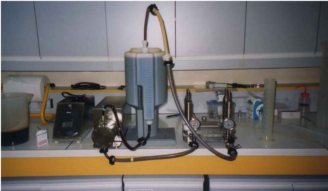
Abbildung 5: Versuchsanordnung (v.l.n.r. Pumpe, Vorratsbehälter, Filtervorrichtung)
