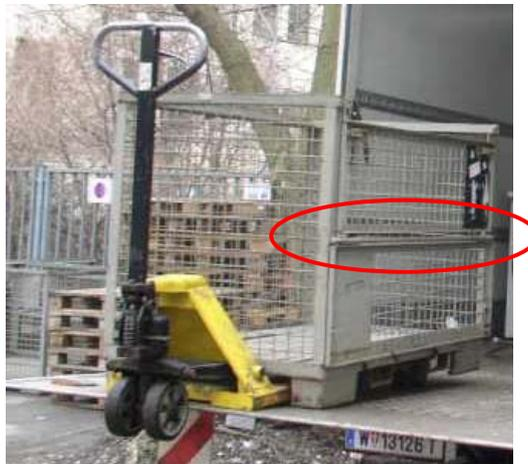
Abbildung 12: Gitterbox mit in der halben Höhe teilbarer Seitenwand
