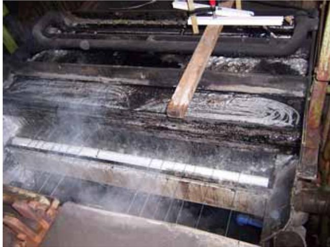
Abbildung 9.26: Vorhang nach der Beize, Messstelle für pH-Wert, Leitfähigkeit- und Temperatur
