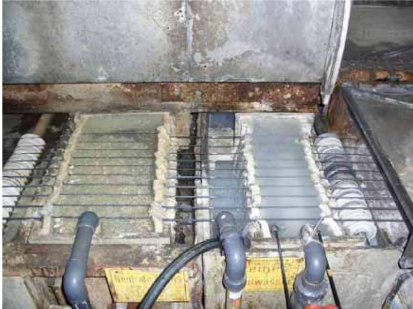
Abbildung 9.24: Rechts: 1. Spülbad nach der Phosphatierung mit Leitfähigkeits- und pH-Temperatursonde, links: 2. Spülbad
