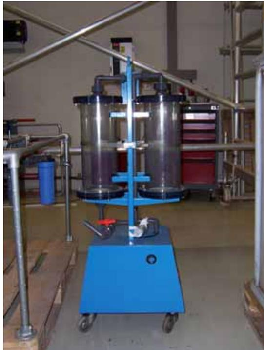
**Abbildung 8.14: Mobile Ionenaustauscheranlage**
