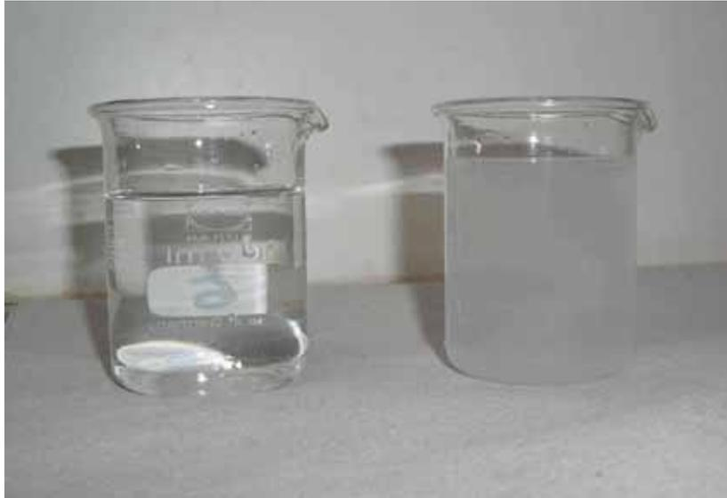
**Abbildung 9.16: Kombination Beutel- (10 $\mu$ m) und Kerzenfilter (1 $\mu$ m): Feed rechts, Filtrat links**
