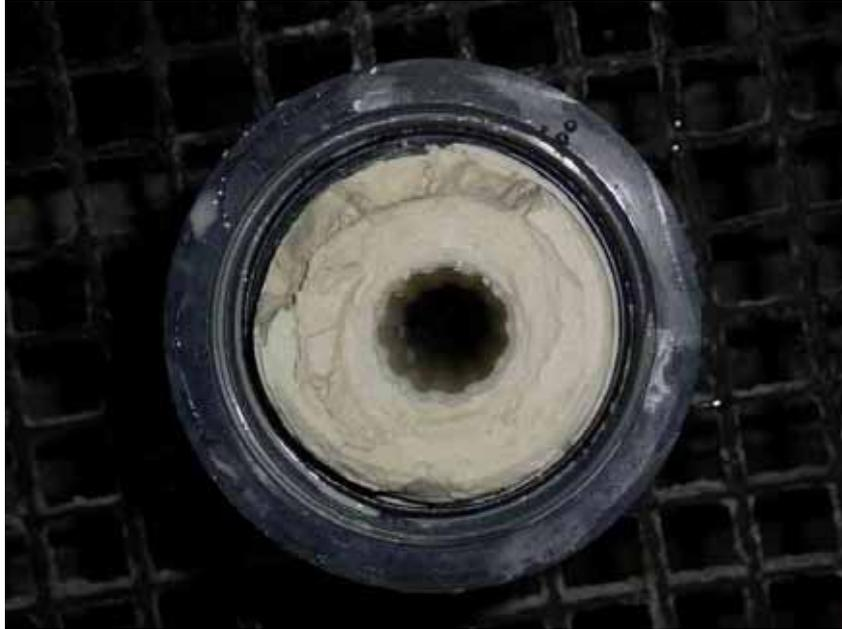
**Abbildung 9.18: Kombination Beutel- (10µm) und Kerzenfilter (1µm): Filterpatrone komplett zugewachsen**
