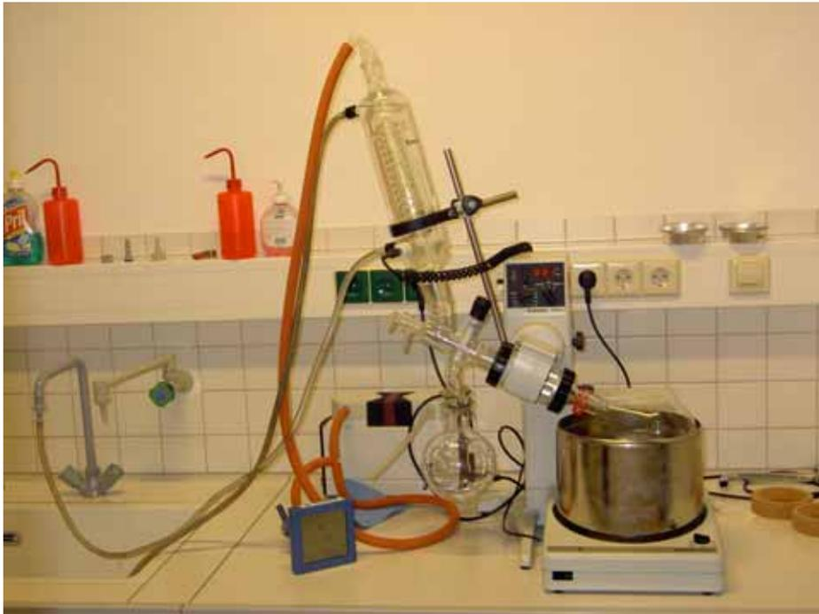
**Abbildung 8.11: Rotovapor für Verdampfungsversuch im Labormaßstab**
