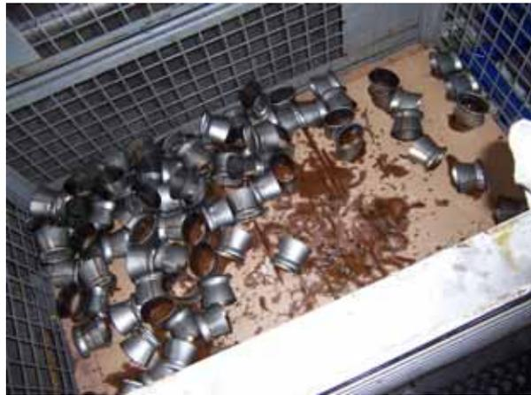
**Abbildung 9.45: Teilwaschanlage und ungereinigte Teile**
