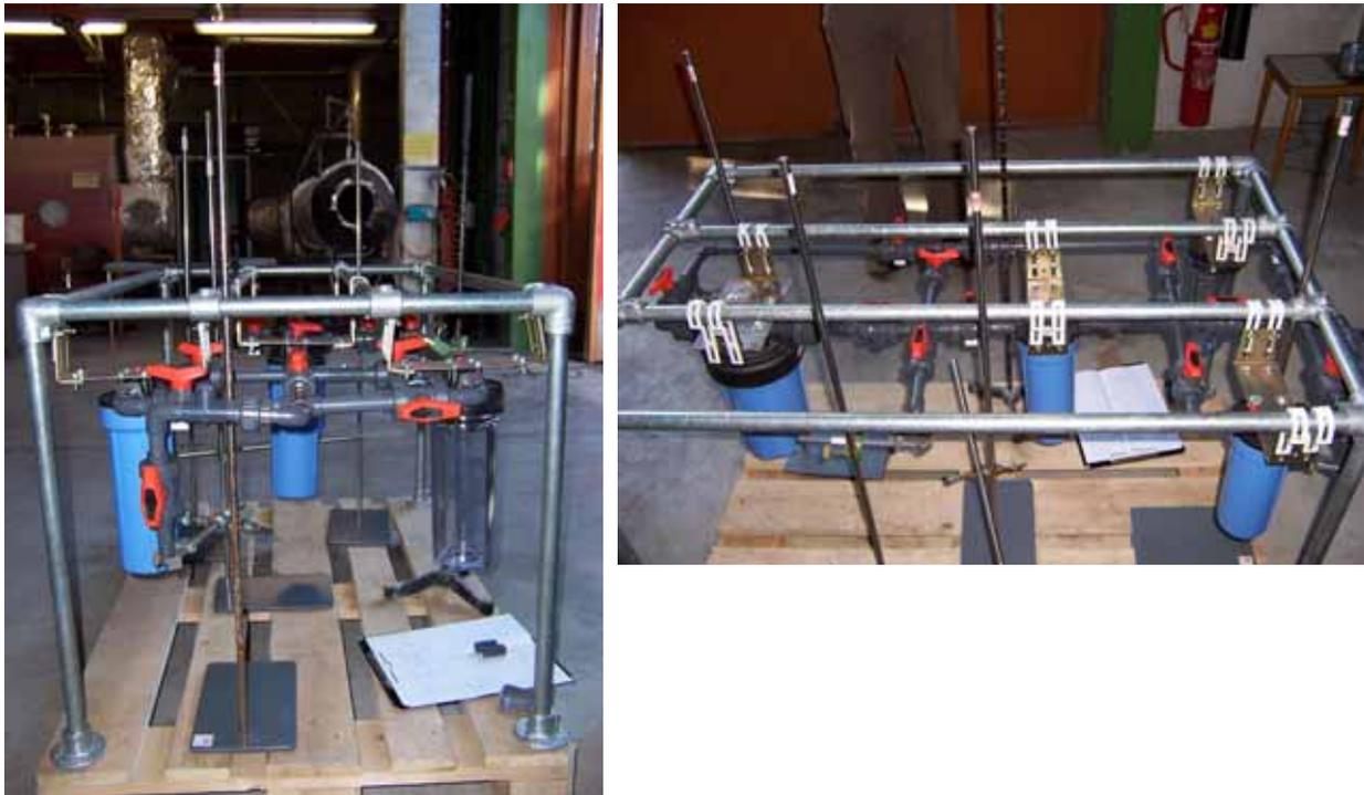
**Abbildung 8.12 und Abbildung 8.13: Filteranlage zum Testen unterschiedlicher Vorfilter und adsorptiver Filtermedien**
