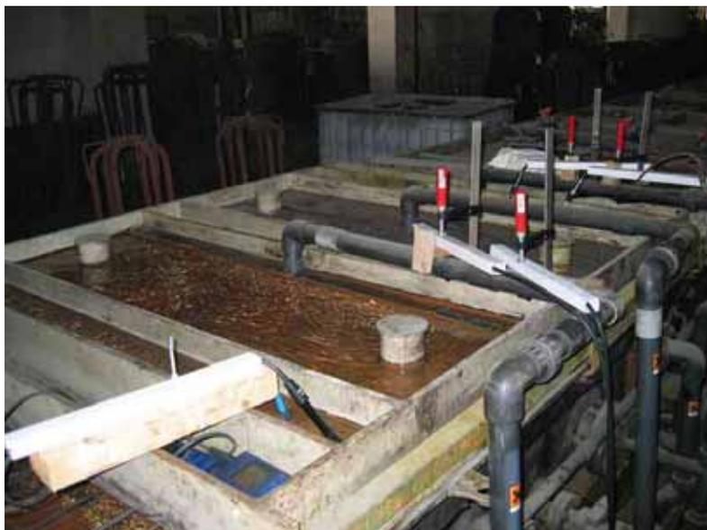
Abbildung 9.23: 3-stufige Fließspülkaskade nach der Beize mit Messaufbau
