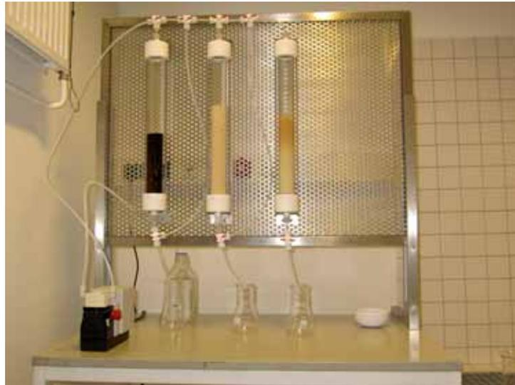
**Abbildung 8.9: Ionenaustauscheranlage für Versuche im Labormaßstab**
