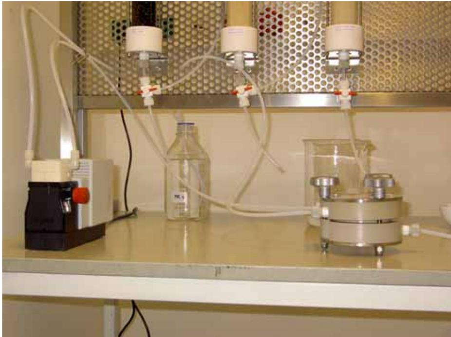
**Abbildung 8.10: Membranfilterzelle für Versuche im Labormaßstab**
