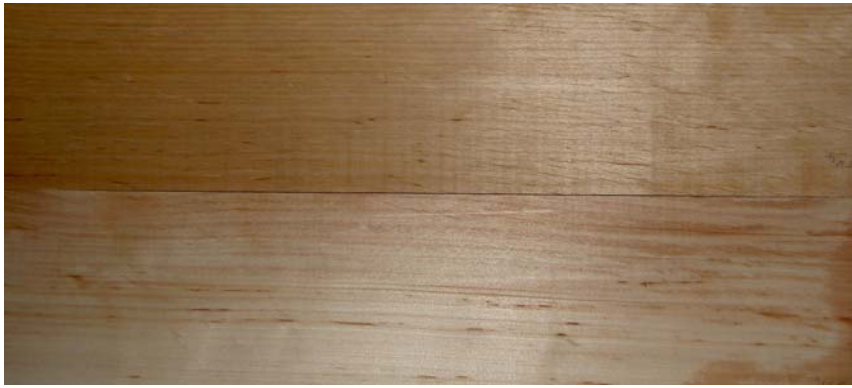
Abbildung 24: Soll-Farbe nach der technischen Erlenschnittholztrocknung (oben) und fleckige Verfärbung der wassergelagerten Bretter (unten)
