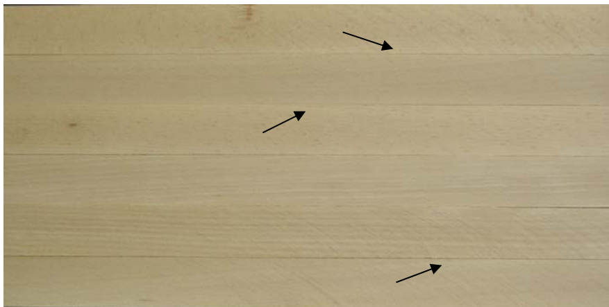
Abbildung 13: Farbmuster Buche nach dem Auftauen bei 40 °C für 7 h (Brettschmalseite)
