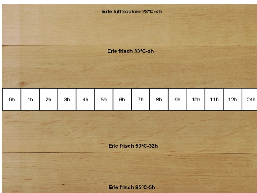
Abbildung 25: Farbvergleich nach UV-Bestrahlung (0 bis 24 h) vier unterschiedlicher Erlenbehandlungen
