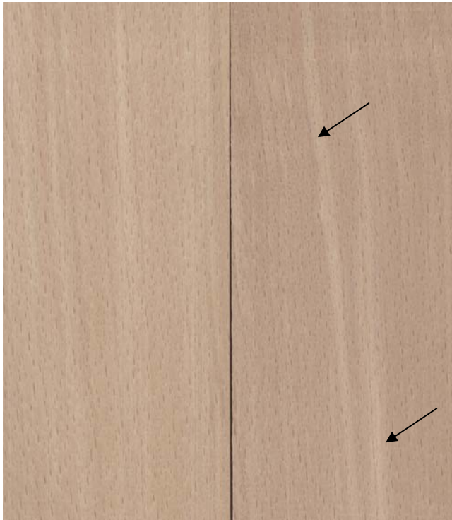
Abbildung 4: Farbstreifen aufgrund ungleichmäßiger Buchendämpfung
