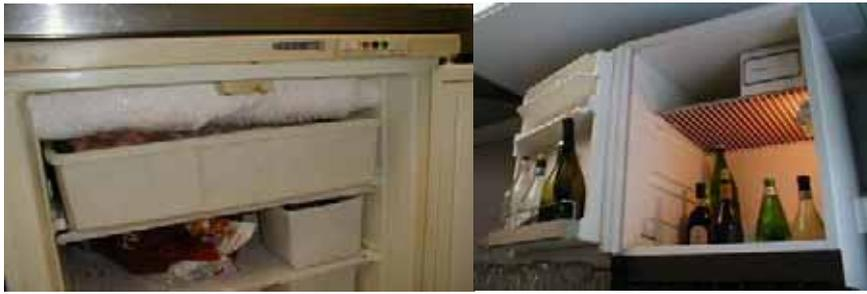
Abbildung 17: Abtauen und fehlende Ausnutzung des Kühlvolumens
