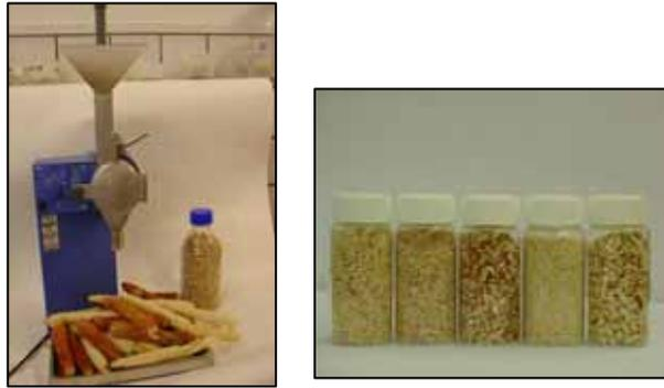
Abbildung 13: Mühle und Fraktionen des Maiskolbengranulats
