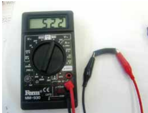
Abbildung 7: Messung der Leitfähigkeit
