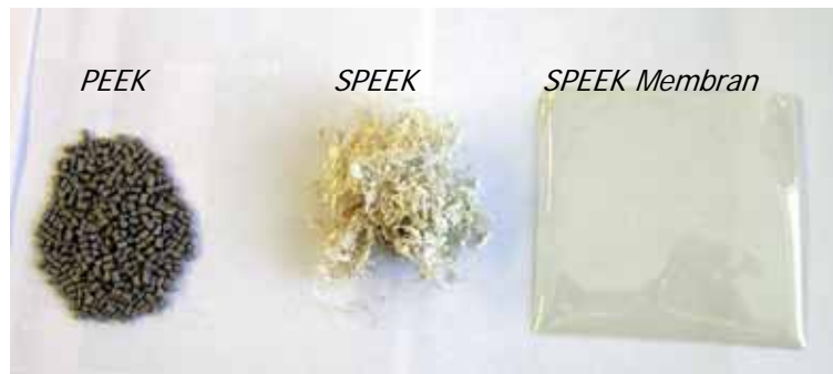
Abbildung 16: Entstehung einer SPEEK Membran aus PEEK
