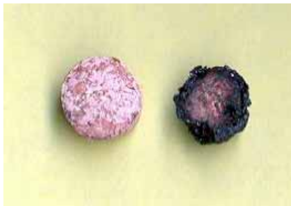
Abbildung 22: Probekörper zur Ermittlung des Schmelzindexes von SPEEK
