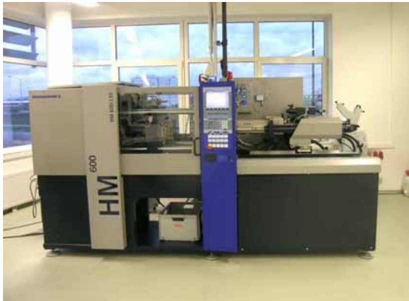
Abbildung 11: Spritzgießmaschine HM 600 der Fa. Battenfeld
