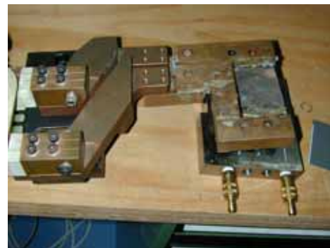
Abbildung 2: Versuchsstand zur Evaluierung der variothermen Prozessführung
