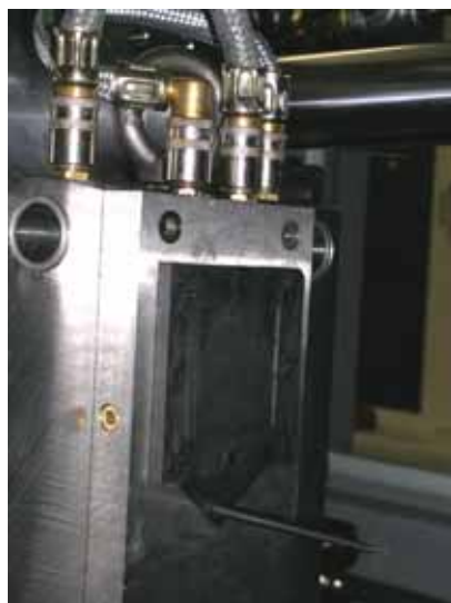
Abbildung 28: Gespritzte Bipolarplatte aus leitfähigem Kunststoff mit Anguss
