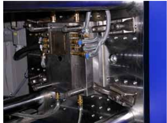
Abbildung 27: Werkzeug zur Herstellung von Bipolarplatten in der Spritzgießmaschine
