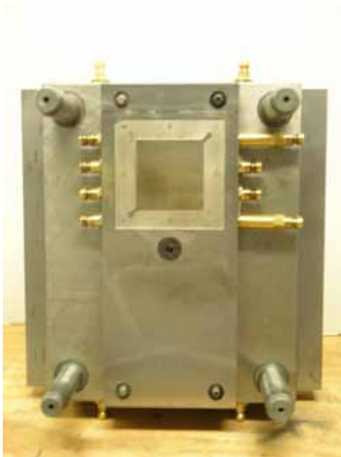
Abbildung 9: Spritzgießwerkzeug für die Herstellung von Bipolarplatten
