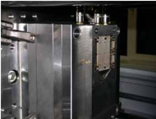
Abbildung 27: Werkzeug zur Herstellung von Bipolarplatten in der Spritzgießmaschine
