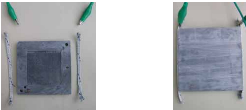
Abbildung 13: Kontaktierung des Prüfkörpers
