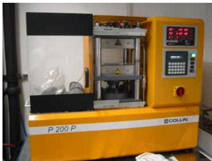
Abbildung 24: Laborheizplattenpresse Collin P200 in geöffnetem Zustand
