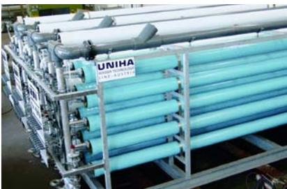
Meerwasser oder Brackwasser enthalten einen hohen Anteil an gelösten Salzen: der Gesamtanteil an gelösten Stoffen beträgt 1.500 bis 45.000 mg/l. Nach einer geeigneten Vorbehandlung kann salzhaltiges Wasser durch die Umkehrosmose-technologie von UNIHA entsalzt werden. Das Medium wird da-
