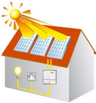
Wechselrichter wandeln in Photovoltaik-Anlagen den von den Solarzellen produzierten Gleichstrom aus Sonnenlicht in haushaltsüblichen Wechselstrom um.
