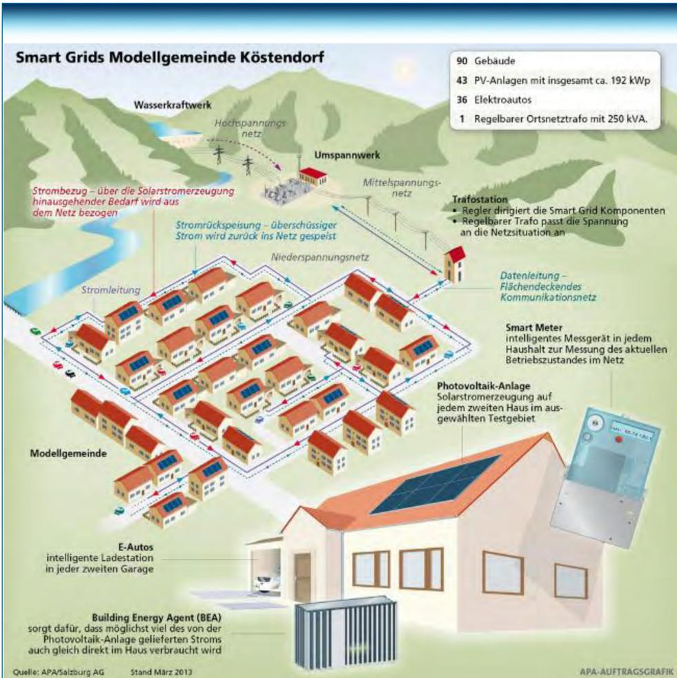
In der Modellgemeinde Köstendorf werden mittels smarter Technologien und Planungsansätze höhere Durchdringungsraten von E-Mobilität und Photovoltaik, als im konventionellen Netzbetrieb möglich ist, umgesetzt.
