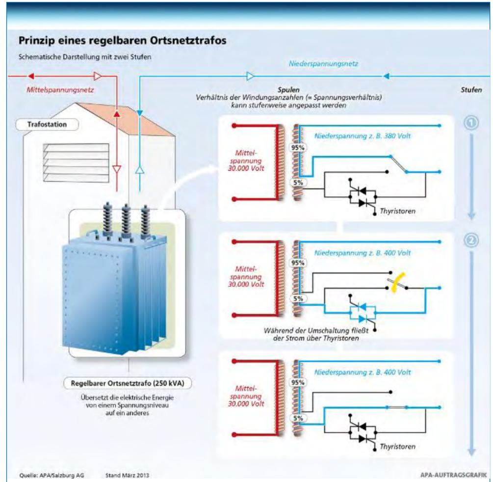
Unter diesen smarten Technologien versteht man zum Beispiel den Einsatz eines regelbaren Ortsnetztrafos, oder steuerbarer Lasten wie z.B. intelligente Ladestationen, die beide ihren Beitrag zur Spannungshaltung und somit zum stabilen Netzbetrieb leisten.
