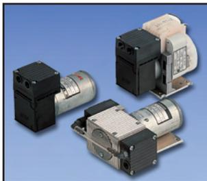
**Das Prinzip der Membranpumpe:** Eine elastische Membrane wird durch einen Exzenter auf- und abbewegt. Im Abwärtshub saugt sie das zu fördernde Gas über das Einlassventil an. Im Aufwärtshub drückt die Membrane das Medium über das Auslassventil aus dem Pumpenkopf hinaus. Der Förderraum ist vom Pumpenantrieb durch die Membrane hermetisch getrennt. Deshalb fördern die Membranpumpen die Medien völlig unverfälscht.
