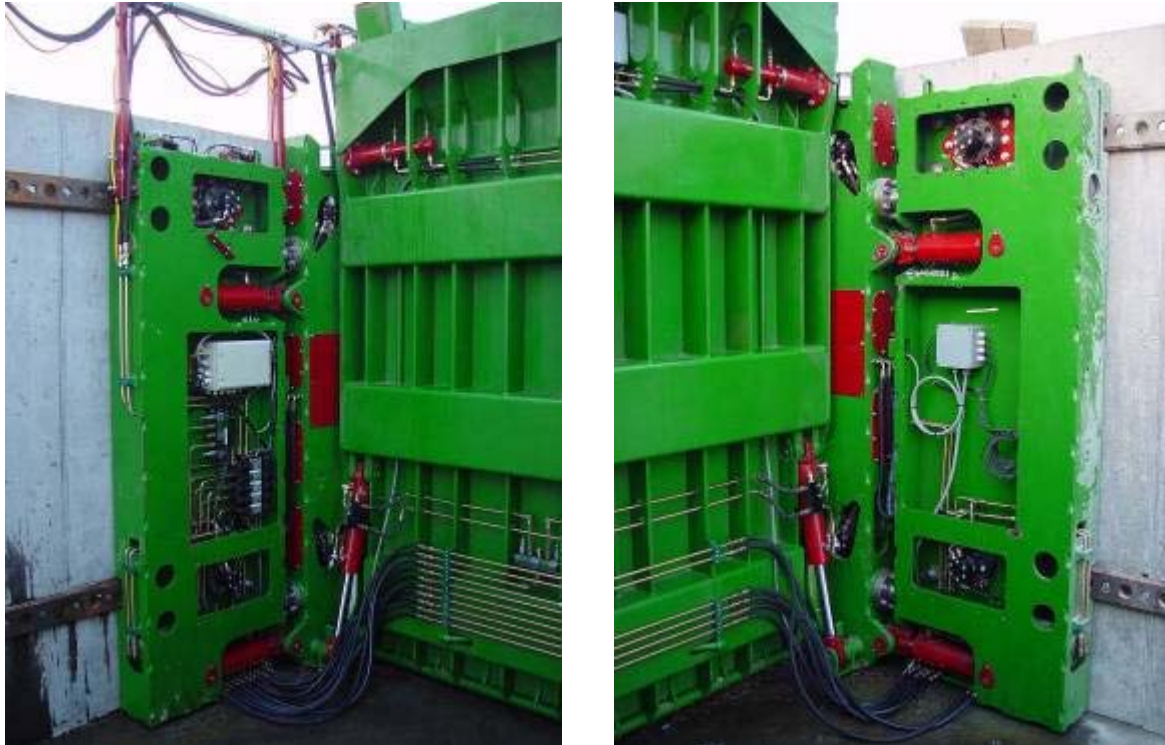
Abbildung 12: Seitenführung mit Vorschubzylindern und Absteckzylinder (linker und rechter Wagen)
