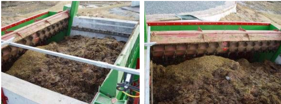
Abbildung 13: Funktionstests mit Grassilage und gepressten Komponenten
