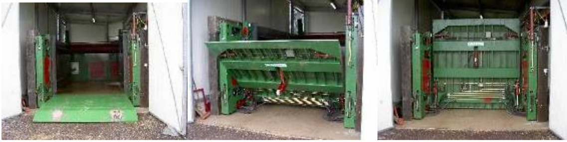
Abbildung 2: Befahrbare Abschiebewand im offenen, angehobenen bzw. geschlossenen Zustand
