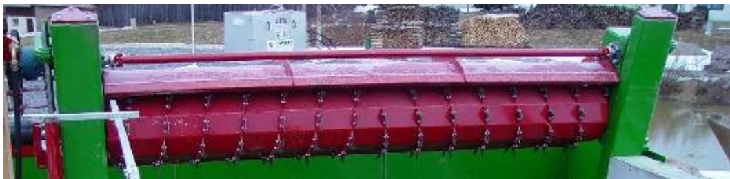
Abbildung 4: Einbringung von Komponenten im losen und gepressten Zustand; Auflösung der Strukturen durch Frästrommel
