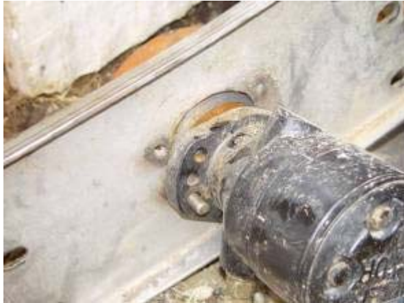
Abbildung 14: Bruch der Klauenkupplung und des Antriebsritzels am Ölmotor bei der Einbringschnecke
