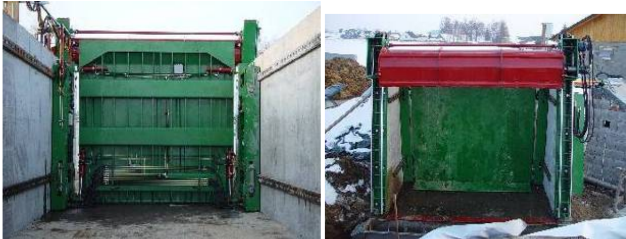
Abbildung 10: Montage der Seitenführungen, Abschiebewand, Fräse und der Quersförderschnecke
