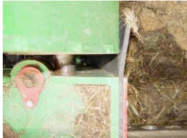
Abbildung 15: Verkeilung des Absteckbolzen auf der Abschiebewand zum Seitenführungswagen (Klappe verzogen)
