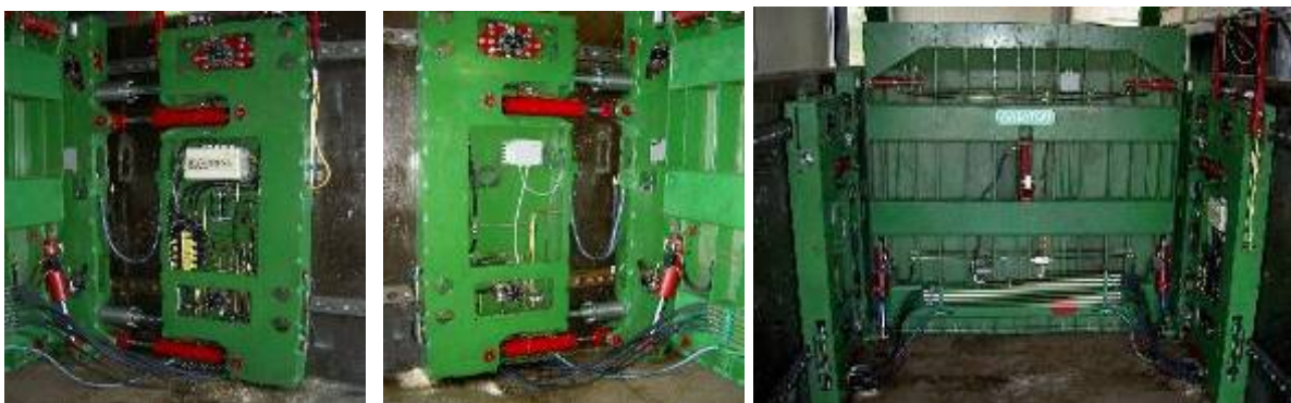
Abbildung 6: rechter und linker Abschiebschlitten mit Ausschub- und Absteckzylinder, Abb. 3 kompl. Abschiebewand geschlossen
