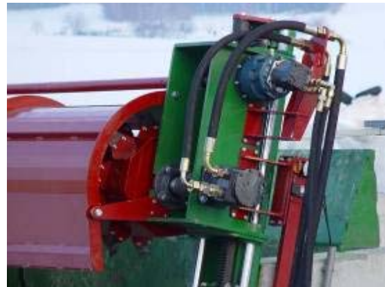
Abbildung 17: Nachtäglicher Aufbau von Bremsmotoren auf Fräsvorrichtung
