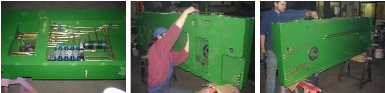
Abbildung 9: Montage der Hydraulikkomponenten, Leitungen, Ventile und der Steuergeräte
