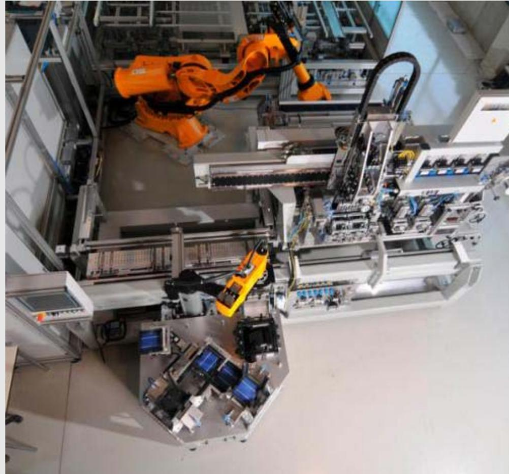
Patentiertes, weltweit einzigartiges Lötconcept - Stringlötung in einem Schritt
