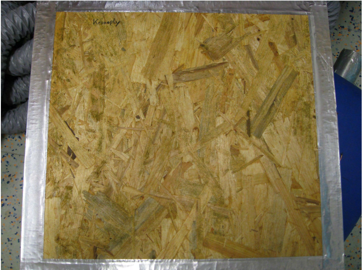
Abbildung 41: Schimmelbefall der OSB-Platte nach 125 Tagen bei etwa 90 %rF.
