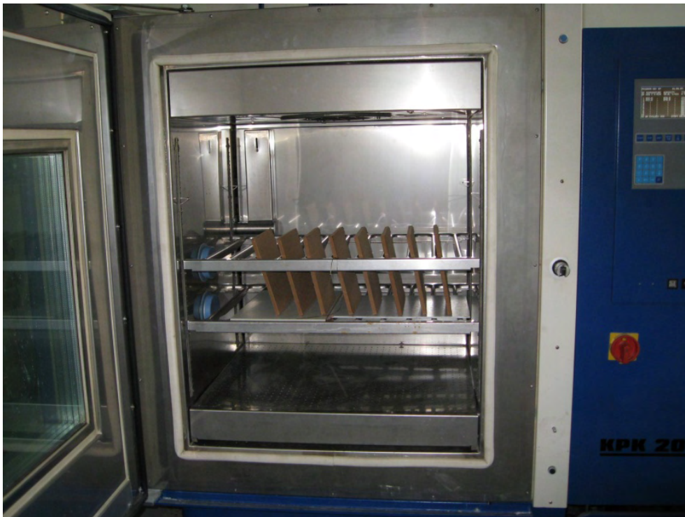
Abbildung 32: Anordnung der Proben im Klimaschrank
