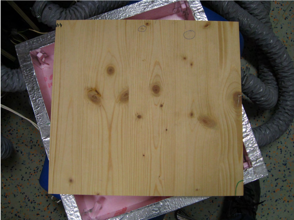
Abbildung 40: Schimmelbefall auf der Rückseite (markierte Stellen)nach 125 Tagen.
