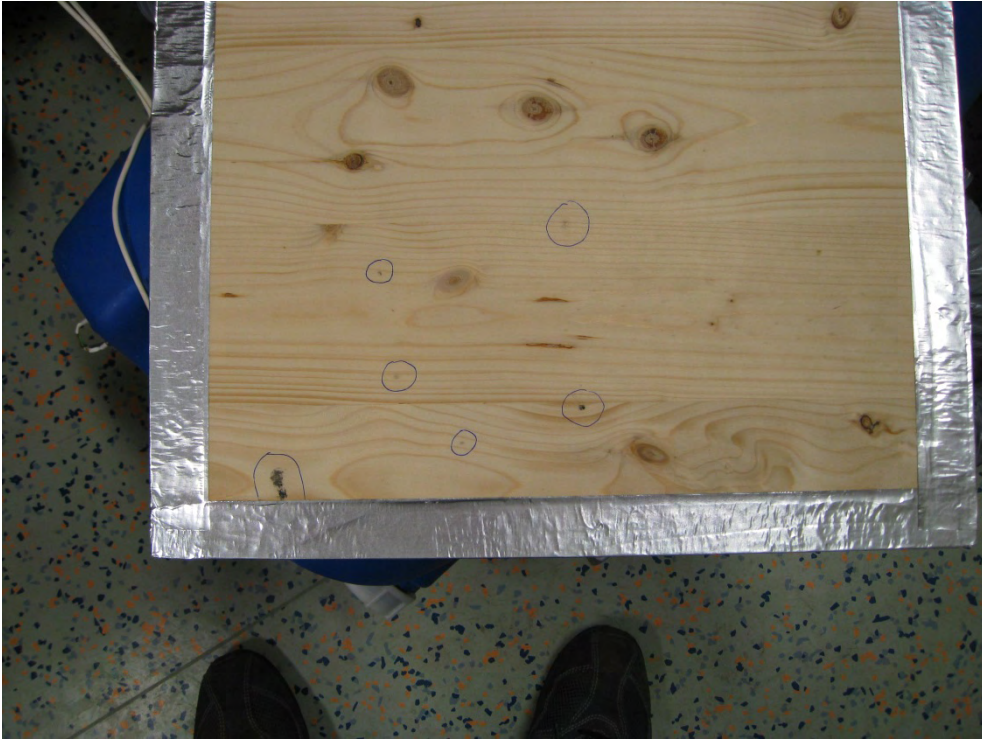
Abbildung 39: Schimmelbefall auf der Vorderseite(markierte Stellen) nach 125 Tagen.
