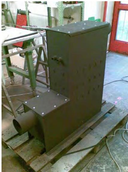
Bild 7: Multifunktioneller Apparat zur Abgaskondensation und Feinstaubabscheidung nach dessen Anlieferung ins Labor
