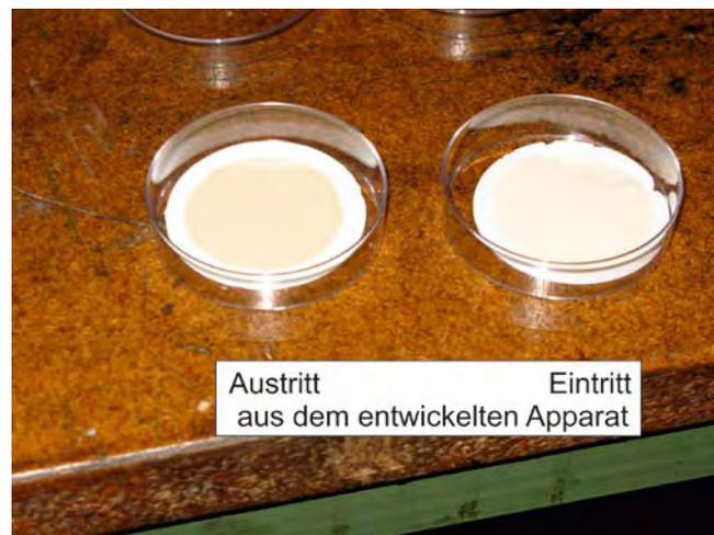
Bild 11: Feinstaubfilterproben vom Ein- und Austritt des multifunktionalen Apparats
