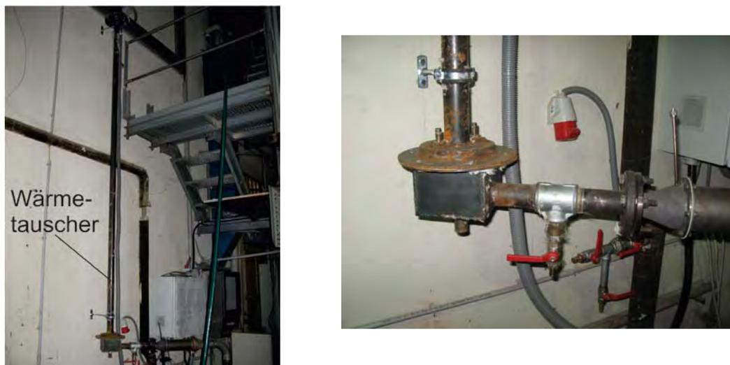
Bild 3: Versuchsstand zur Bestimmung des konvektiven Wärmeübergangs einer erzwungenen Rohrströmung trockener bzw. feuchter Luft
