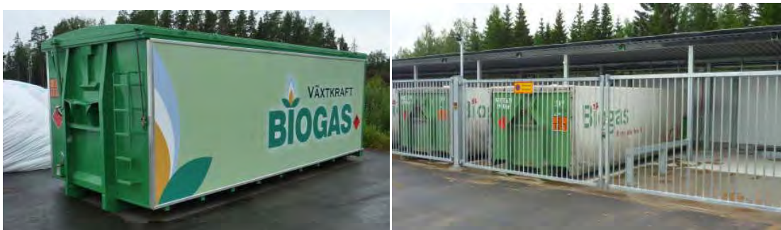
Abbildung 14: Mobiler Gasspeicher zur Versorgung von Biogas-Inseltankstellen (Quelle: New Energy)
