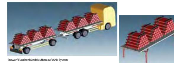
Entwurf Flaschenbündelaufbau auf WAB-System
