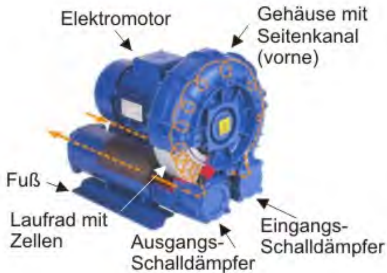
Abbildung 6: Beispielbild einer Seitenkanalverdichters mit Gasweg, [25]
