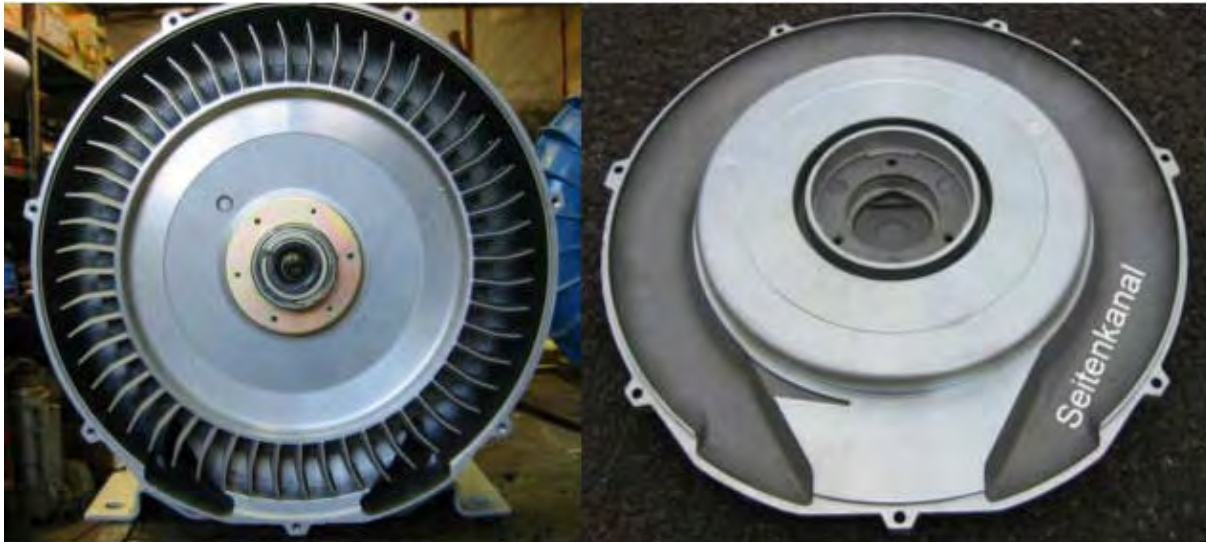
Abbildung 8: Geöffneter Seitenkanalverdichter; mit Laufrad (links) und Seitenkanal (rechts), [25]
