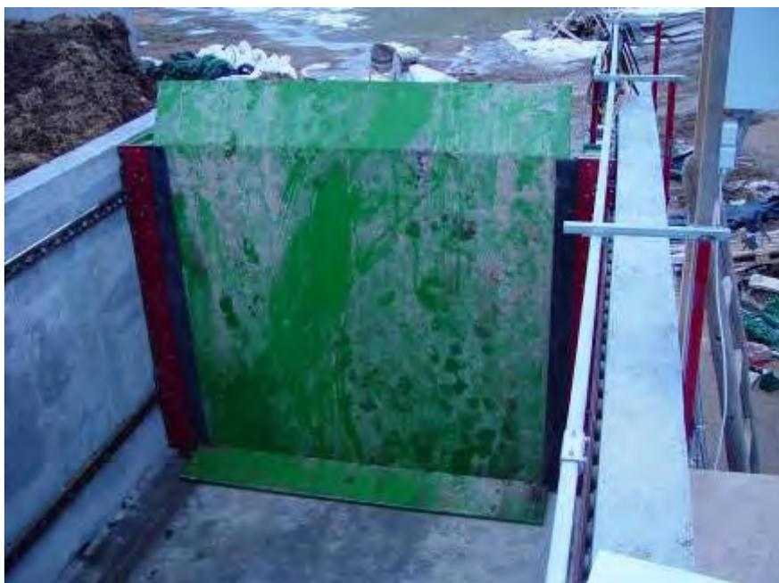
Abbildung 20: Aufbau der Abschiebewand und Funktionstest des Absteckmechanismus der Hydraulikzylinder
