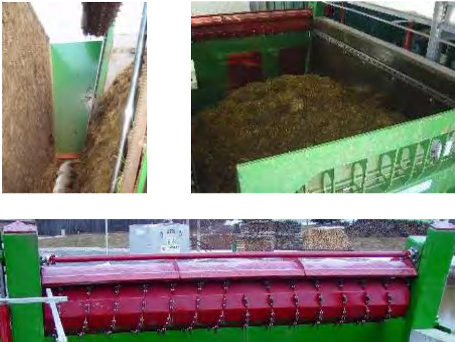
Abbildung 8: Einbringung von Komponenten im losen und gepressten Zustand; Auflösung der Strukturen durch Frästrommel
