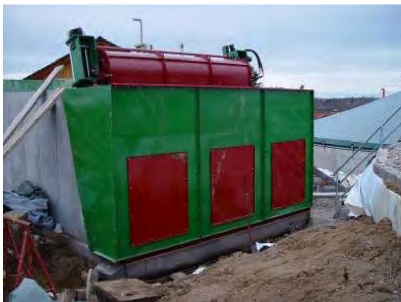
Abbildung 30: Fräsvorrichtung mit Einhaus und Quersörderschnecke aus Edelstahl
