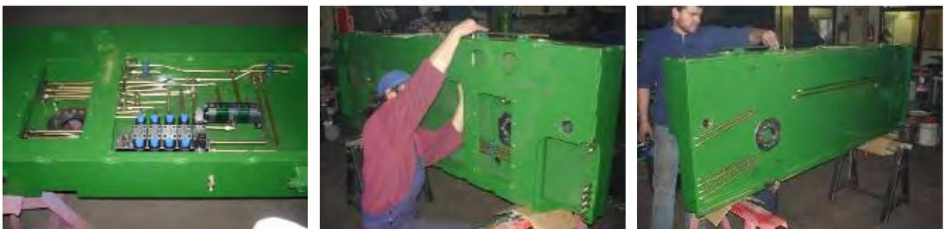
Abbildung 18: Montage der Hydraulikkomponenten, Leitungen, Ventile und der Steuergeräte
