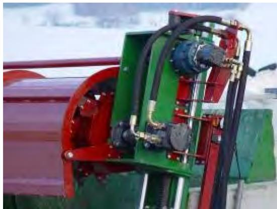
Abbildung 28: Nachtäglicher Aufbau von Bremsmotoren auf Fräsvorrichtung
