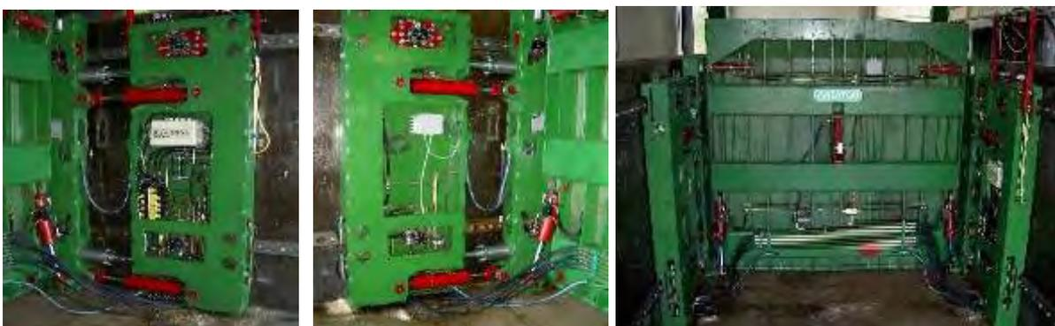
Abbildung 13: rechter und linker Abschiebschlitten mit Ausschub- und Absteckzylinder, Abb. 3 kompl. Abschiebewand geschlossen
