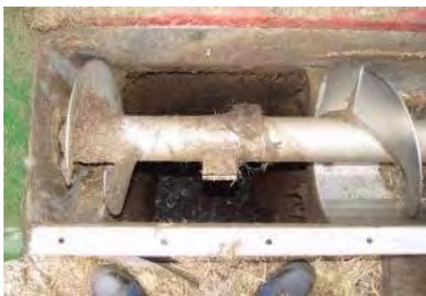
Abbildung 27: Umbau der Einbringschnecke, da Quickmixpumpe nicht die vorgegebene Leistung erbrachte
