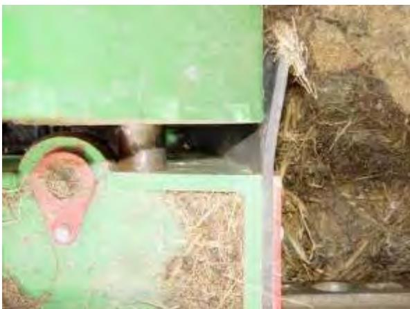
Abbildung 26: Verkeilung des Absteckbolzens auf der Abschiebwand zum Seitenführungswagen (Klappe verzogen)
