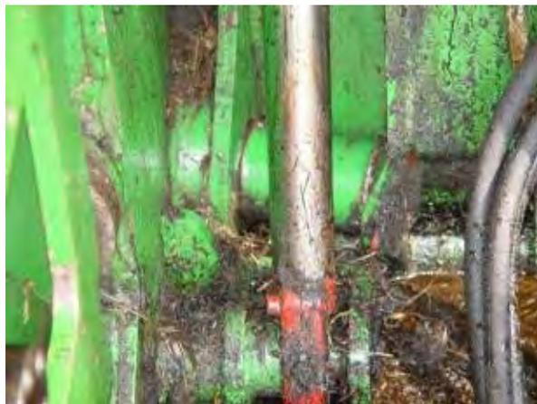
Abbildung 24: Durchbiegung des Bolzens bzw. der Büchsen bei der Abschiebwand (komplette Demontage )
