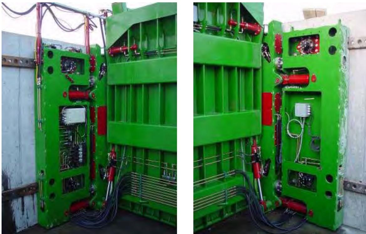
Abbildung 21: Seitenführung mit Vorschubzylindern und Absteckzylinder (linker und rechter Wagen)
