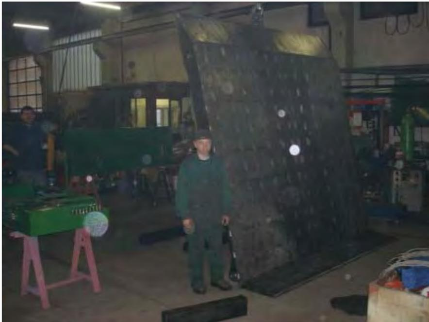
Abbildung 17: Anfertigung von Schweißkonstruktionen ( z.B. Abschiebeklappe )
