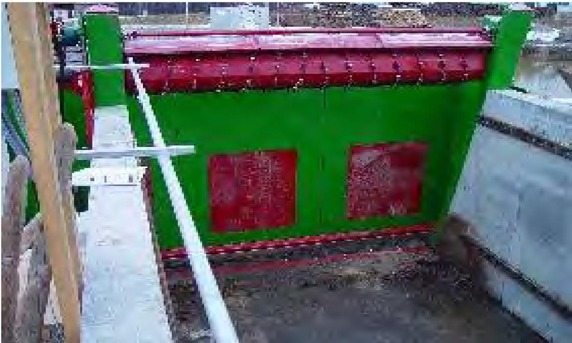
Abbildung 7: Hydraulisch angetriebene Frästrommel und Querförderschnecke für die Verarbeitung aller anfallenden Substrate
