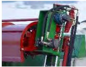
Abbildung 5: Hydraulischer Fräsantrieb und Fräsvorschub
