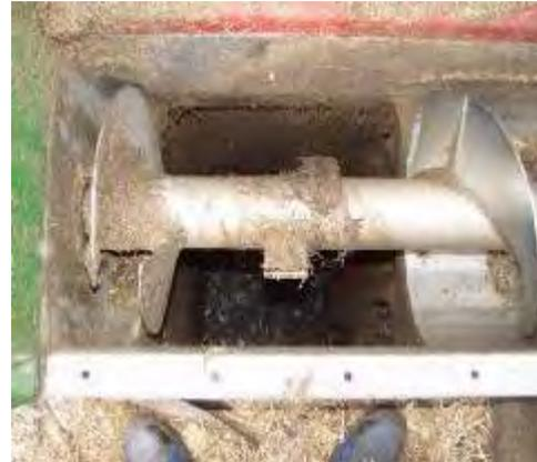
Abbildung 10: Übergang von der Querförderschnecke zum Fallschacht
