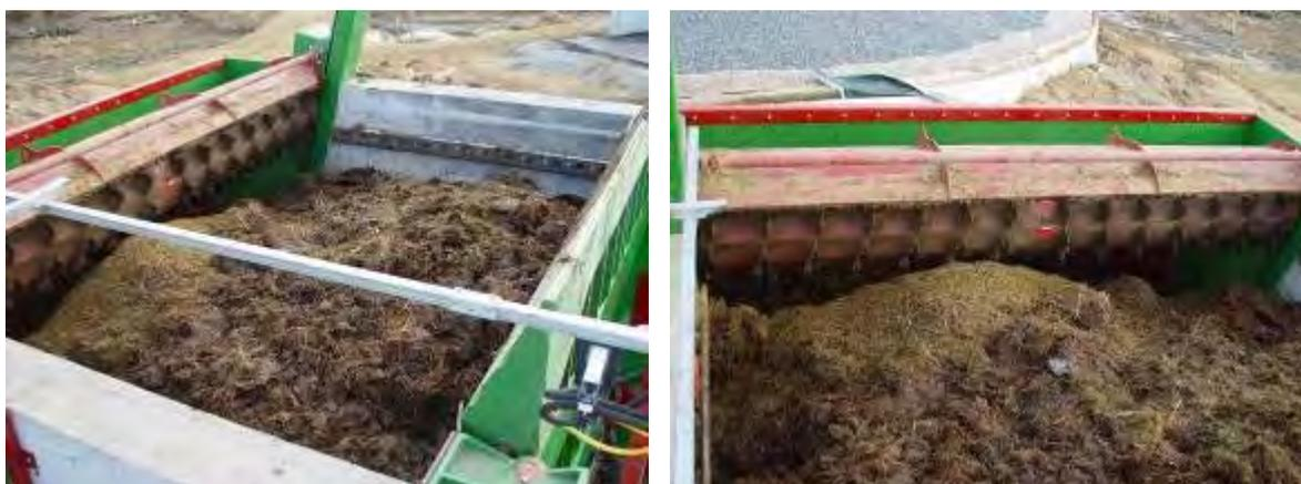
Abbildung 22: Funktionstests mit Grassilage und gepressten Komponenten
