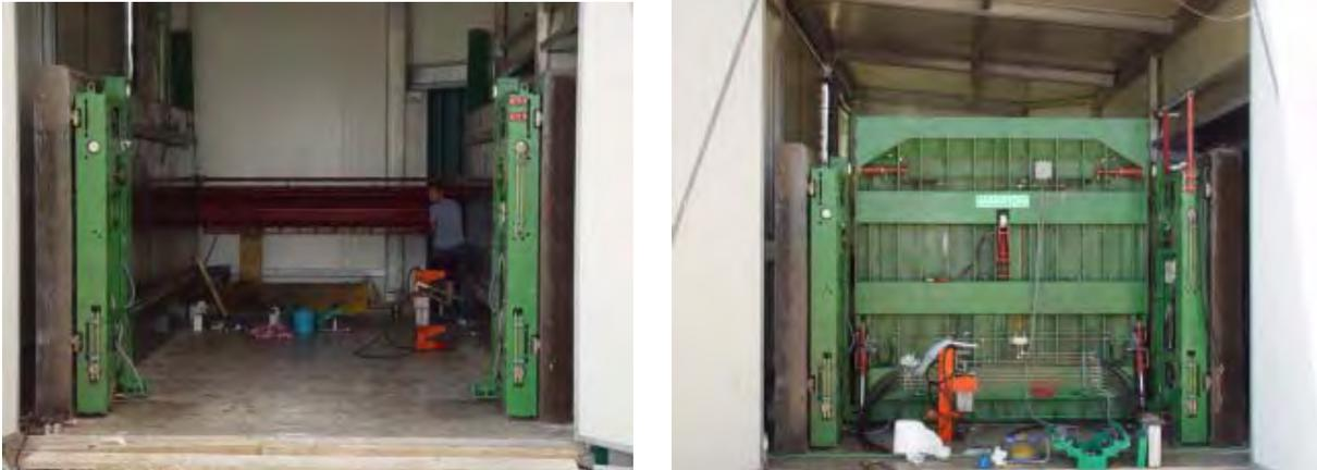
Abbildung 31: Aufbau des Prototypen – Einbau der Fräse und der Abschiebewand im überdachten Feststoffbehälter
