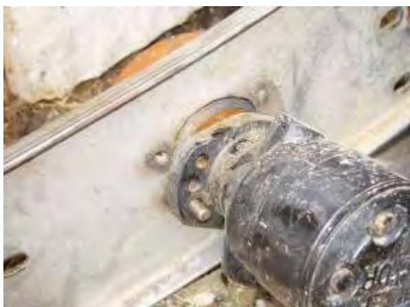
Abbildung 25: Bruch der Klauenkupplung und des Antriebsritzels am Ölmotor bei der Einbringschnecke
