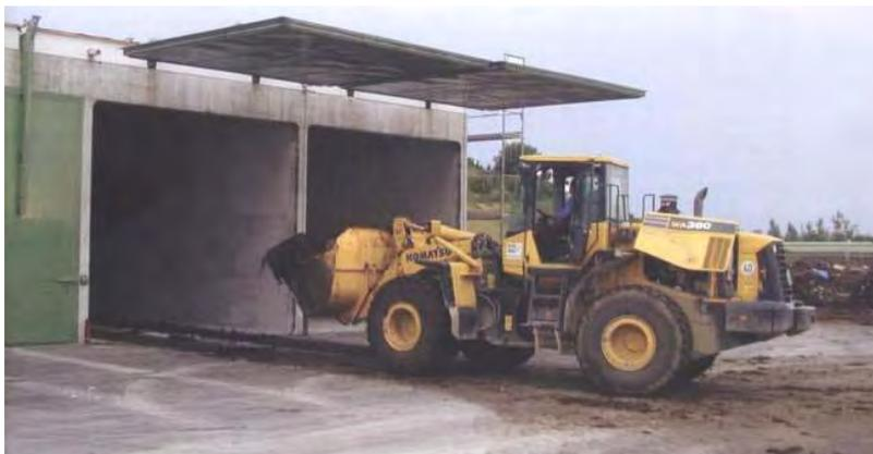
Abbildung 9: Beispiel einer Trockenvergärungsanlage für pflanzliche Rohstoffe (Silage) mit Gärkammern („Garagen“) und typischer Beschickung/Entleerung mittels Frontlader
