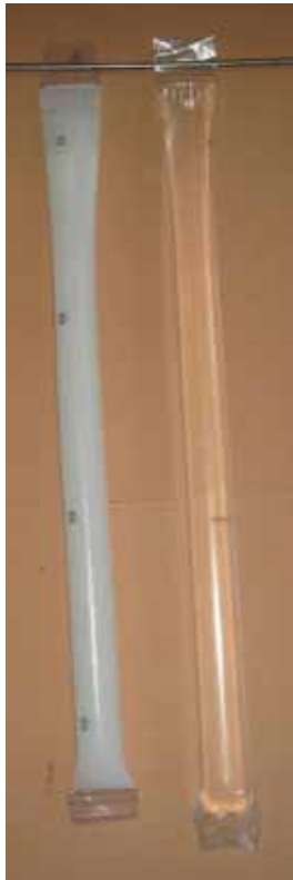
Abbildung 6.1: Folienmodule mit Paraffinfüllung im festen (links) und flüssigen (rechts) Zustand
