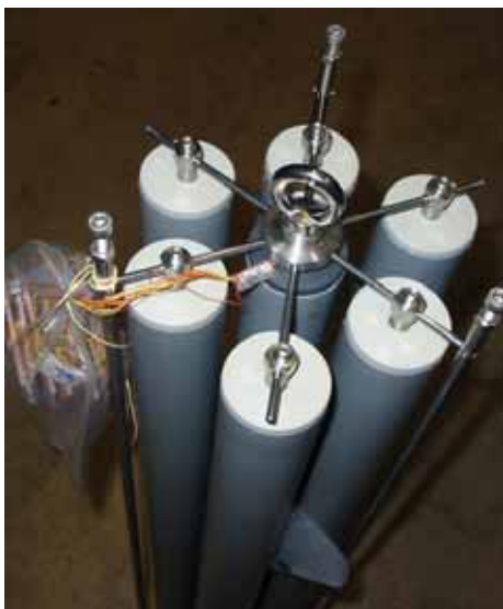
Abbildung 6.5: Aufnahmerahmen mit Kunststoff-Rohrmodulen
