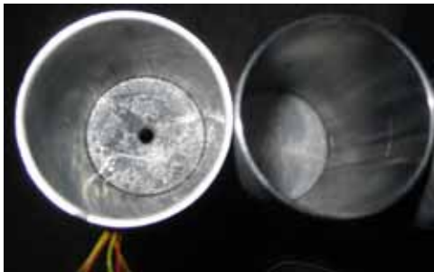
Abbildung 6.4 Tabletten mit zentraler Bohrung im Modul zur Aufnahme von Thermoelementen (links), Standardmodul mit Tabletten (rechts)
