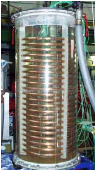
Abbildung 7.2: Glattrohrwärmetauscher im Versuchsspeicher (hier gefüllt mit Wasser)
