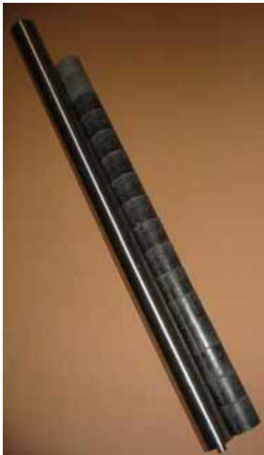
Abbildung 6.3: Modul mit Salzhydrat-Graphit-Tabletten vor der Befüllung
