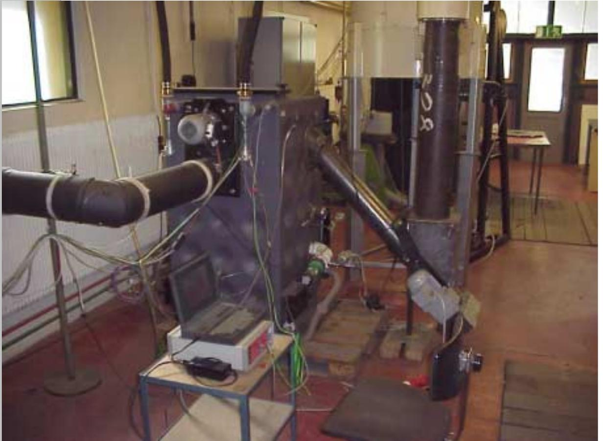
Bild 1: Regelungs-Versuchsstand mit der für die weiteren Untersuchungen verwendeten 50 kW-Biomassefeuerung, die von der Fa. Herz als beteiligtem Industriepartner für die Dauer des Projekts zur Verfügung gestellt wurde.
