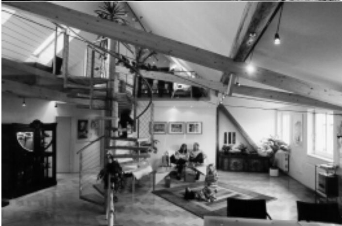
Objekt in Kärnten, Dachausbau im 5. Stock mit 18 kWh/m 2 a (LEKwert) und einer Energiekennzahl von 32 kWh/m 2 a ohne Wärmerückgewinnung. Mit Wärmerückgewinnung würde man auch gut bei 15 kWh/m 2 a liegen.
