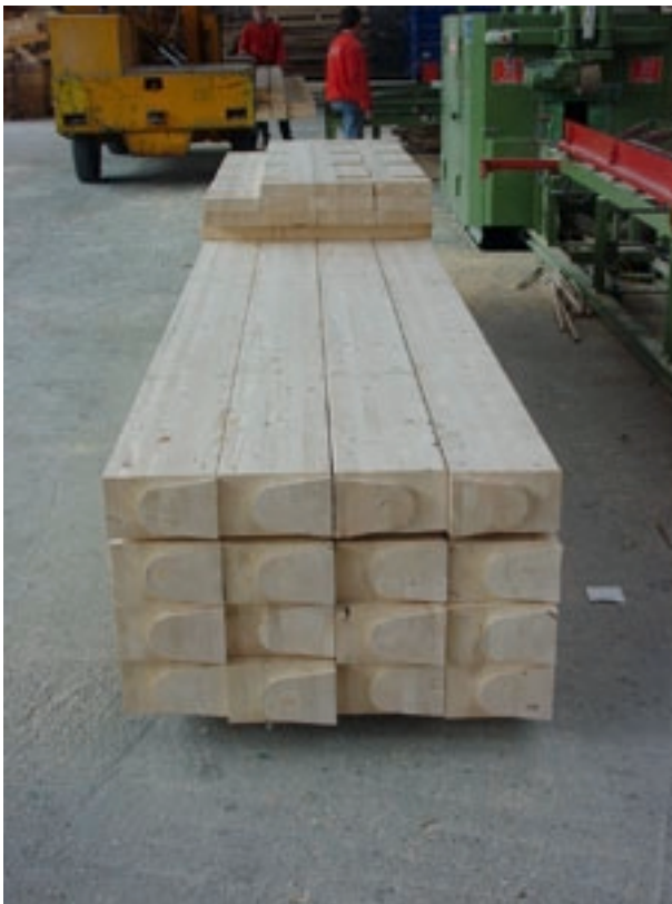
Abb. 8.3.1 Herstellung der Schwalbenschwanzverbindungen. Der Vollholzquerschnitt (mit Kern) der oberen Bilder wurde nur zur Kalibrierung der Fräse verwendet. Im Prototyp wurden BSH-Querschnitte eingesetzt (Bilder unten)
