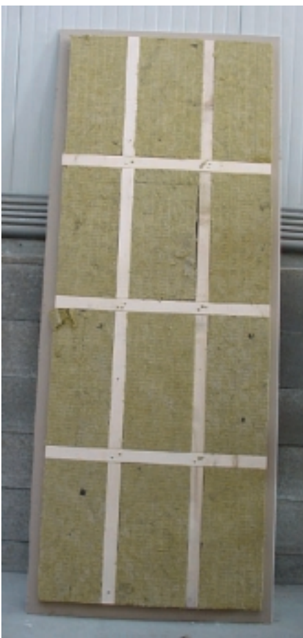
Abb. 8.3.3: Vorsatzschale Typ A (links unten). Prototyp vor den Schallmessungen mit provisorischen Wänden (rechts unten)
