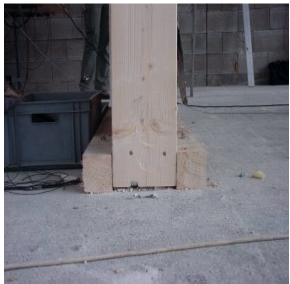
Abb. 8.5.8: (Gelenkige) Fixierung der Fußpunkte
