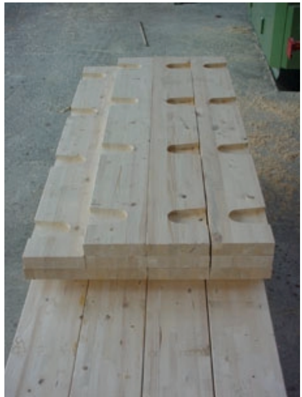
Abb. 8.3.1 Herstellung der Schwalbenschwanzverbindungen. Der Vollholzquerschnitt (mit Kern) der oberen Bilder wurde nur zur Kalibrierung der Fräse verwendet. Im Prototyp wurden BSH-Querschnitte eingesetzt (Bilder unten)
