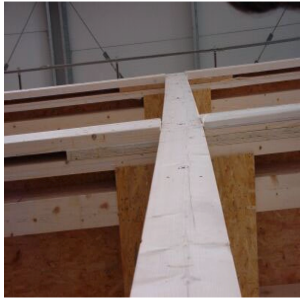
Abb. 8.5.11: Verformung der mittleren Stütze beim statischen Versuch
