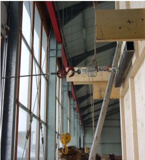
Abb. 8.5.10: Kraftmessdose Kraftaufbringung durch Seilwinde außerhalb der Halle
