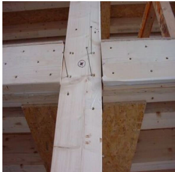
Abb. 8.5.12: Verformung des mittleren Knotens beim statischen Versuch
