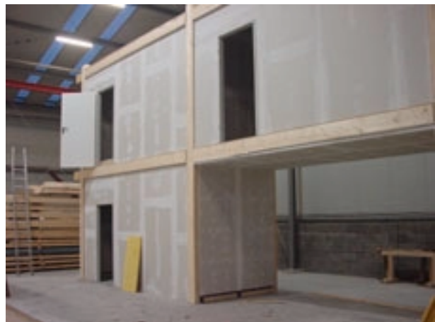
Abb. 8.3.3: Vorsatzschale Typ A (links unten). Prototyp vor den Schallmessungen mit provisorischen Wänden (rechts unten)
