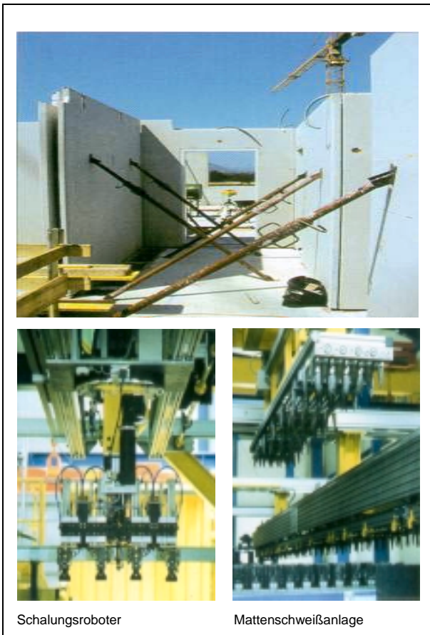
Abb. 2.13: Katzenberger Doppelwandsystem mit Vorsatzschale [Quelle: Firmenprospekt, Firma Katzenberger]
