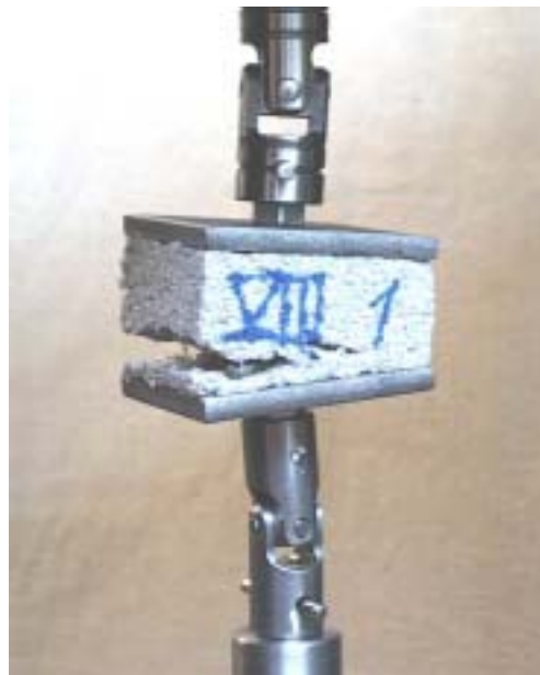
Abb. 54 Eingebauter Zelluloseprüfkörper nach dem Lastspiel
