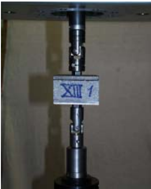
Abb. 53 Eingebauter Zelluloseprüfkörper vor dem Lastspiel
