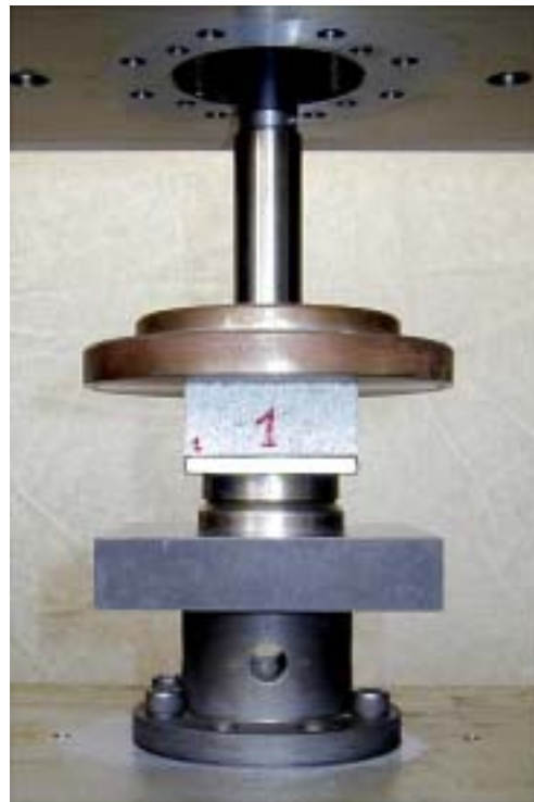
Abb. 47 Bestimmung der Druckspannung Unter der Probe ist ein Kugelkalotten-Auflager zur zentrischen Lastverteilung zu sehen
