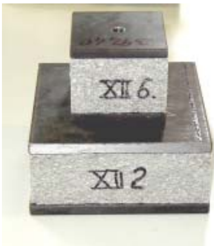
Abb. 51 Prüfkörper 8 x 8 und 15 x 15 cm
