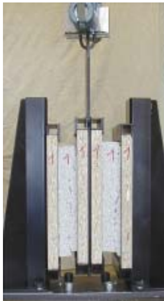
Abb. 50 Bestimmung der Scherfestigkeit
