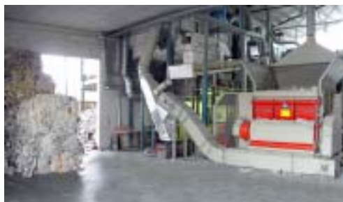
Abb. 11 Anlieferung und Grobzerkleinerung des Zeitungspapiers im sog. Shredder
