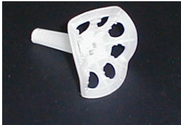
Abb. 4-51: Verformter Tellerdübel nach durchgeführtem Versuch.
