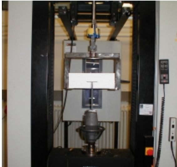
Abb. 4-4: Allgemeiner Versuchsaufbau für Ausziehversuch mit Formschlussgeometrie.
