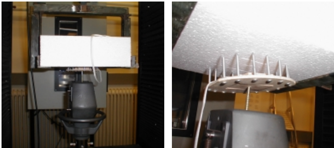
Abb. 4-48: Zeigt einen Nagelteller, der einen mehrfachen Reibschluss darstellt. Links ist der schematische Aufbau, rechts eine Detailaufnahme kurz vor Ende des Versuches erkennbar.
