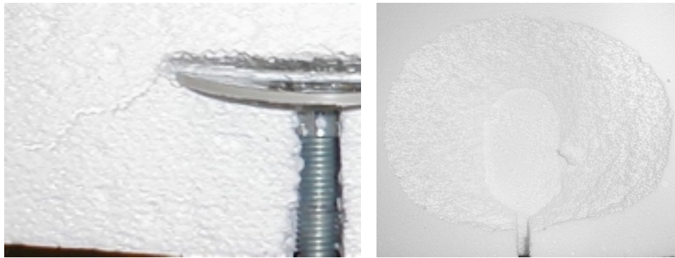
Abb. 4-5: Bruchverhalten der Hartschäume beim Formschlussversuch. Linke Abbildung zeigt typische Rissbildung erkennbar durch geringe Frästiefe, rechts ist der Bruchkegel einer geprüften Probe zu sehen.
