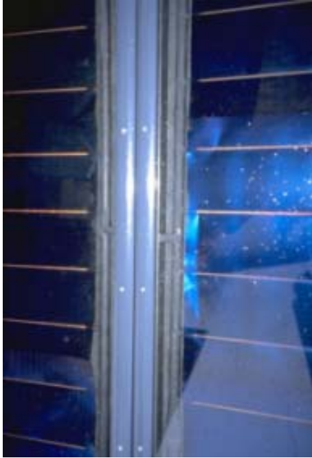
Abbildung 3.6: Kupferabsorber mit glatter Glasabdeckung. Im rechten Absorberfeld sind Unebenheiten sowie Schäden am Absorber (weiße Flecken) erkennbar.
