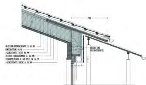
Geschosswohnungsbau Bruckmühl, Details: Fassadenschnitt gesamt 1+2, Details Traufe.
