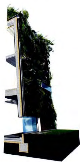
Mercator Sportplaza, Amsterdam: Filzsubstrat vor und nach der Begrünung, Fassadenschnitt und Rendering. Fotos © Luuk Kramer, Amsterdam
