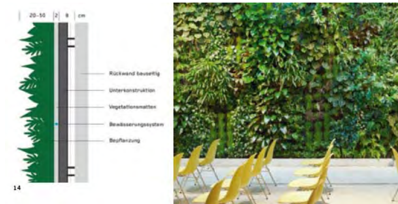
System „Wonderwall“: Systemschnitt, Innenraumbegrünung im HydroLab in Zürich. Plan + Foto © Creaplant, Gerlafingen
