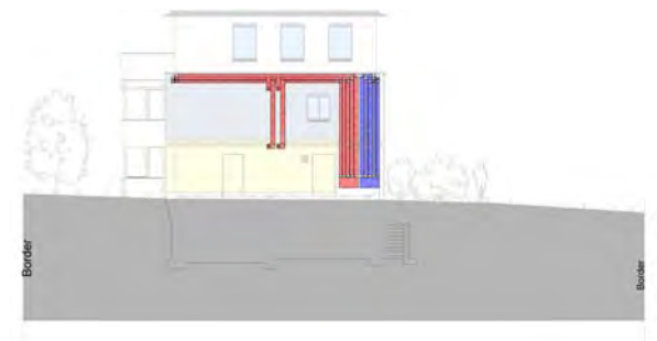
Mehrfamilienhaus Zürich Höngg: Fassadenpaneele mit Feuerschutz-Lüftungskanal, eingebaute Lüftungsrohre mit Dämmung, Montage, Verbindung der Teleskop-Lüftungsrohre, Lüftungskanäle Südostfassade, Lüftungskanäle Nordostfassade. Fotos, Grafiken © Kämpfen für Architektur, Beat Kämpfen
