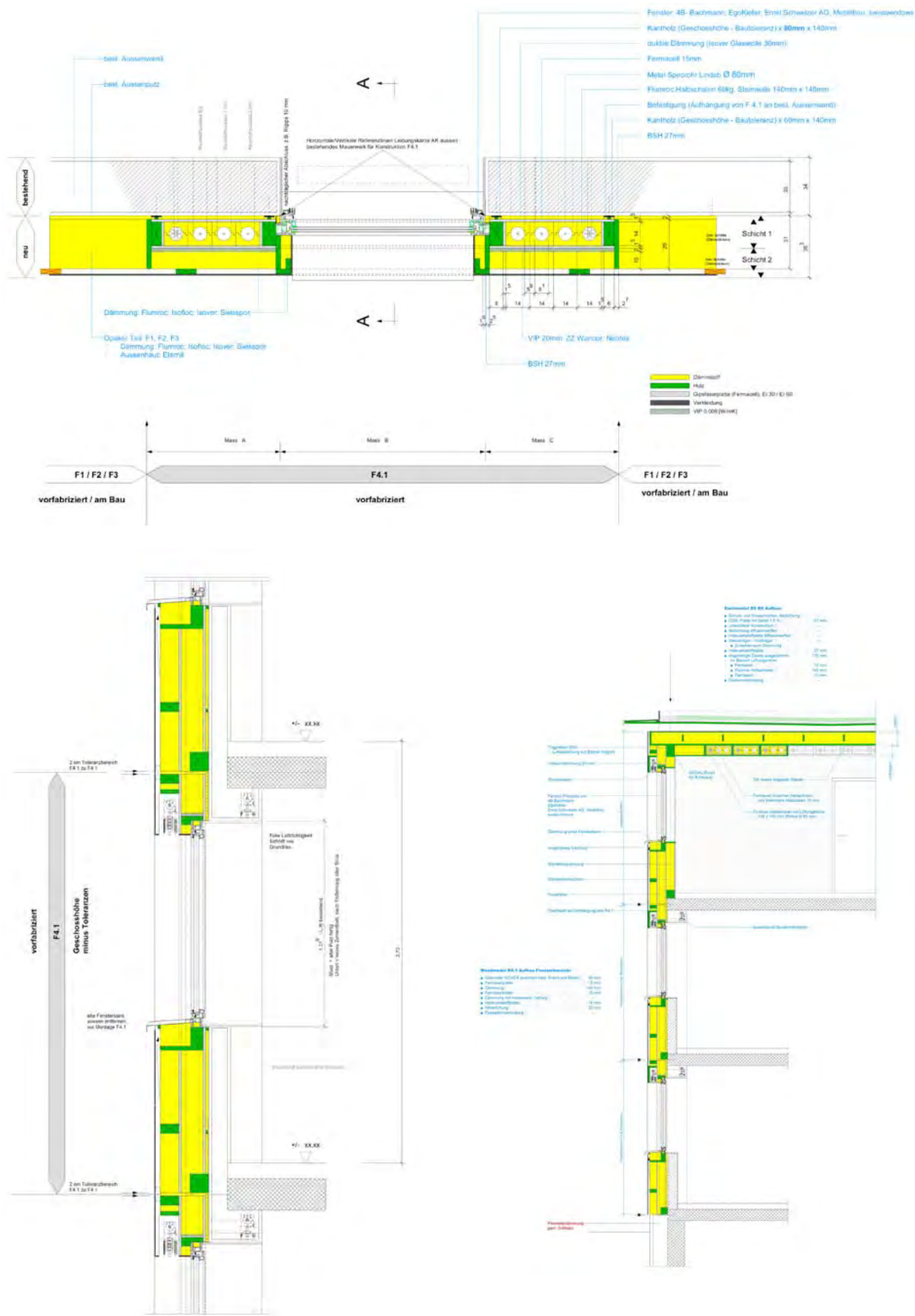
IEA Annex 50 Basis-Fassadenmodul Details: Explosionszeichnung Basismodul, Horizontalschnitt, Vertikalschnitt, Fassadenschnitt. Grafiken © FHNW, René L. Kobler
