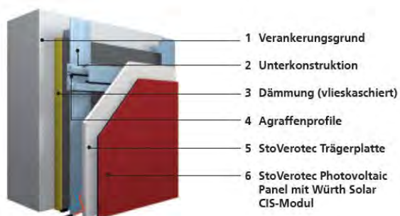
StoVerotec Photovoltaic : Fassadenpaneel Modell, realisierte Testfassade. Grafiken, Fotos © StoVerotec
