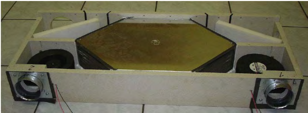
Bad Aibling: Prototyp des Zuluftbausteins. Fotos © Schankula Architekten
