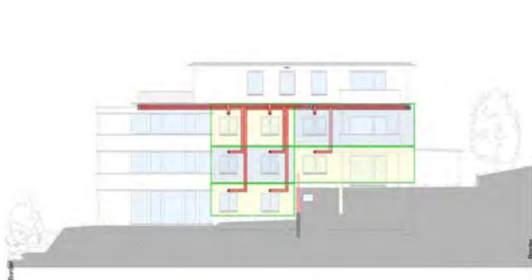
Mehrfamilienhaus Zürich Höngg: Fassadenpaneele mit Feuerschutz-Lüftungskanal, eingebaute Lüftungsrohre mit Dämmung, Montage, Verbindung der Teleskop-Lüftungsrohre, Lüftungskanäle Südostfassade, Lüftungskanäle Nordostfassade. Fotos, Grafiken © Kämpfen für Architektur, Beat Kämpfen
