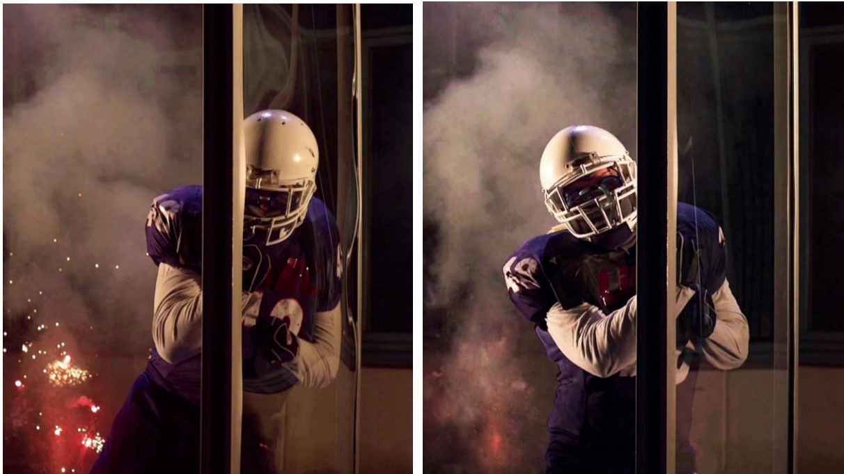
Abbildungen 17, 18 und 19 Belastungstest Dünnglas (©Lisec)
