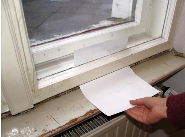
Abbildung 2: Prüfung der Luftdichtheit von Fenstern in unsanierten Gebäuden
