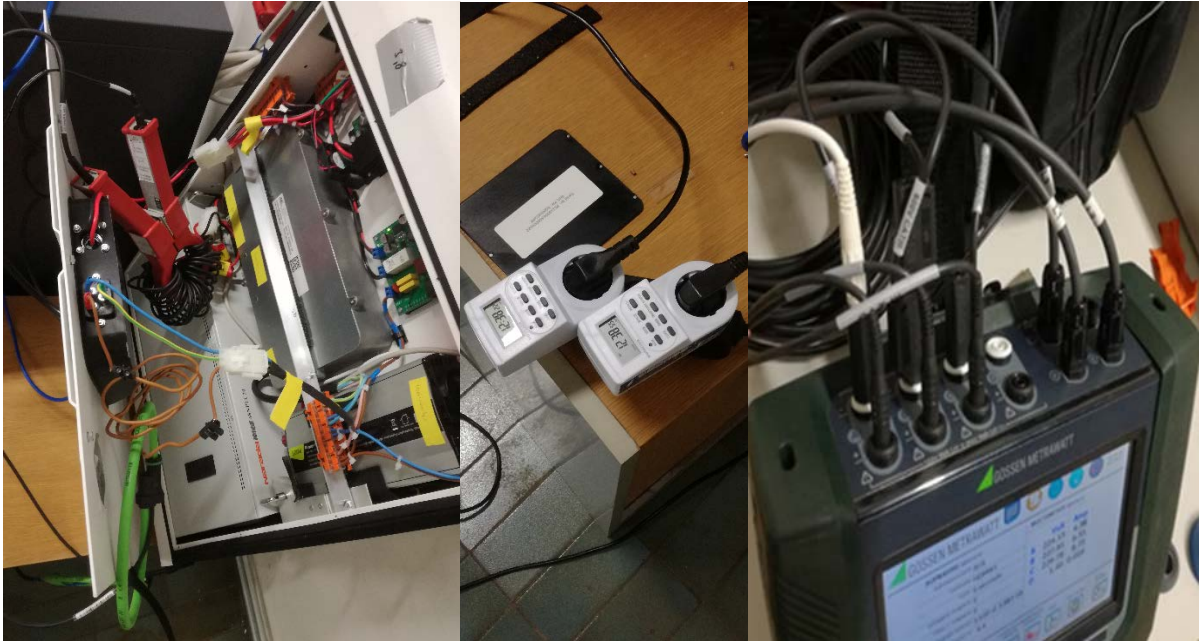
Abbildung 18: Einsatz von Gleichstrom-Messzange und Rogowsky-Spule im SolMate (links), Zeitschaltuhren (mittig) und Messgerät von Gossen (rechts)
