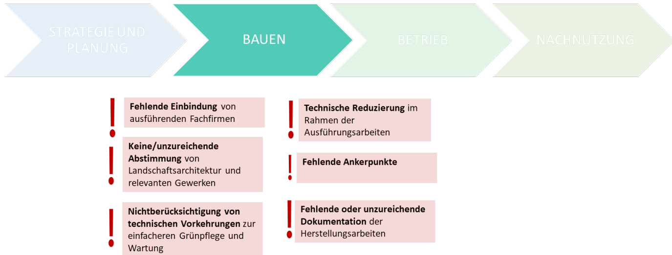
Abbildung 39: Prozesskette mit Fokus auf die Knackpunkte in der Bauphase – Planung (Quelle: eigene Darstellung; Projektteam greening UPI, 2021)
