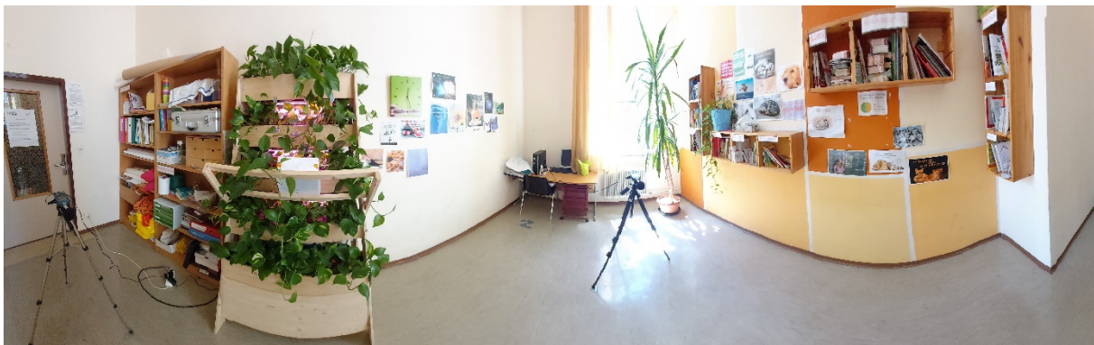
Abbildung 13: 360°-Aufnahme von Raum 101 mit positionierter Begrünungsmaßnahme und zwei Mikrofonen zur Messung der Nachhallzeit
