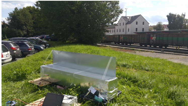
Abbildung 32: Eines im Rahmen des Projektes erstelltes Photonic Cooling Funktionsmuster beim Außentest. Aufnahme vom 04.09.2017, Weiz.
