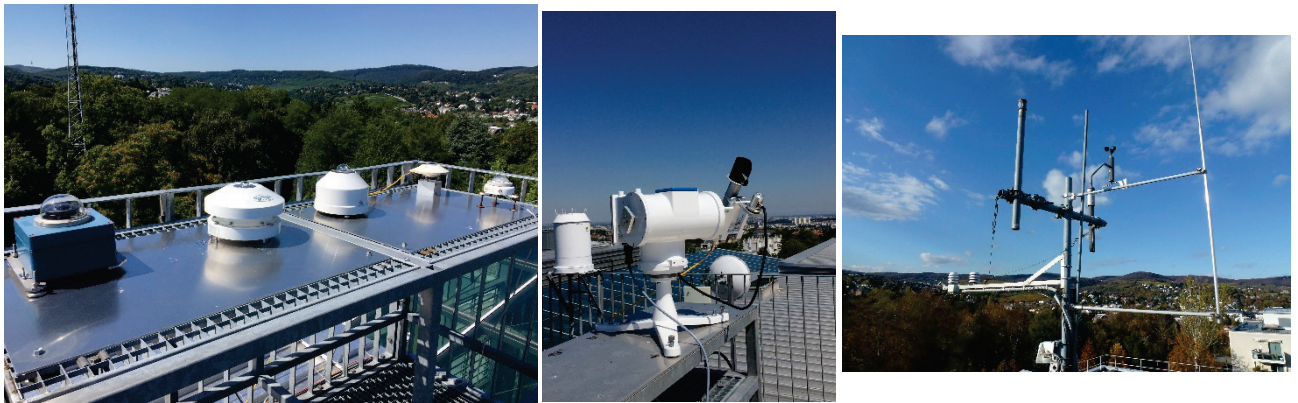
Abbildung 3: Links: Teil der Messstation (Wolkenkamera, Globalstrahlung und langwellige Strahlung) auf der Dachplattform Schwackhöferhaus in 26 m Höhe über Grund. Mitte: Suntracker mit Pyrheliometer. Rechts: Temperatur-, Feuchte- und Windmessstation.
