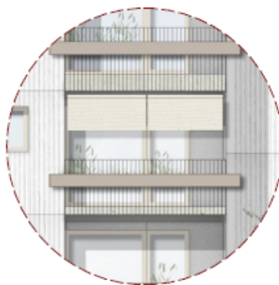
Abbildung 47: Textiler Sonnenschutz Balkone
