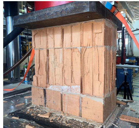
Abbildung 21: links: Versuchsergebnis des Testpfeilers; rechts: Bruchbild des Testpfeilers
