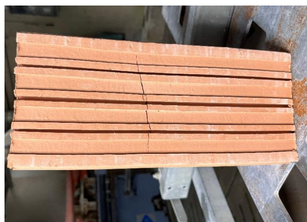
Abbildung 16: links: Pressling mit Querriss direkt nach dem Pressen; rechts: Ziegel mit Querriss nach dem Brennen
