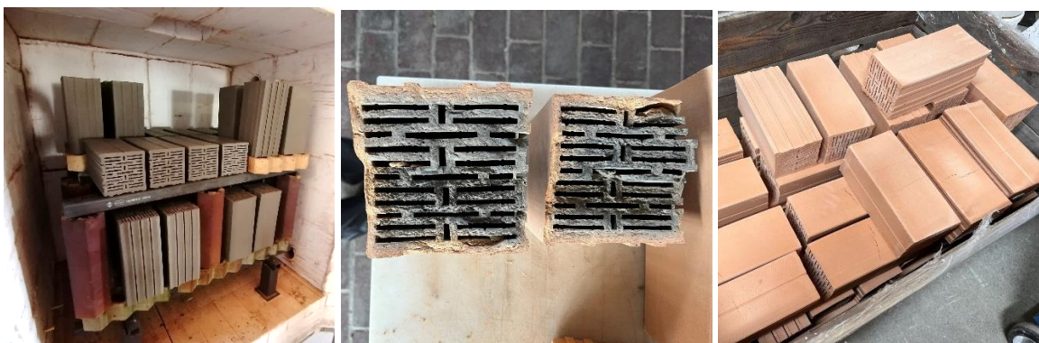
Abbildung 7: links: Ziegel vor dem Brennen; Mitte: Ziegel mit schwarzem Kern; rechts: Ziegel nach dem angepasstem Brennprozess
