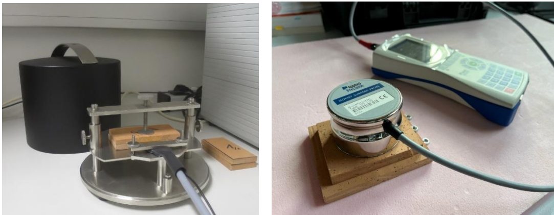
Abbildung 9: links: Messaufbau des Hot-Disk-Verfahrens; rechts ISOMET Messung
