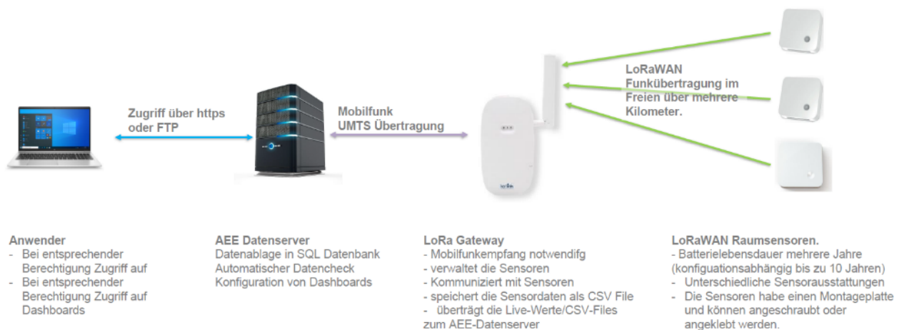
Abbildung 57 Kommunikationsstruktur des LoRaWAN-Funk-Datenloggers und Fernwartung
