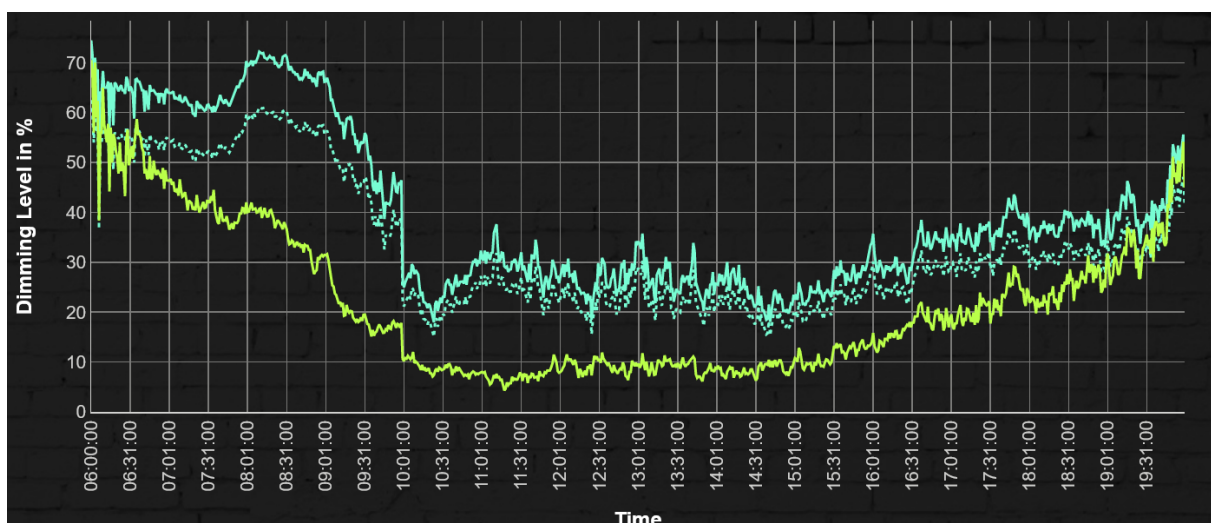
Abbildung 9: Tageszeitlicher Verlauf des Kunstlicht-Dimmung (Mittel über alle Beleuchtungszone, getrennt nach Oberlichtseite (grün) und Fensterseite (türkis); Mittel über den Betrachtungszeitraum 07.2021-12.2021; Beschränkt auf die Uhrzeit 06:00 Uhr-20:00 Uhr)
