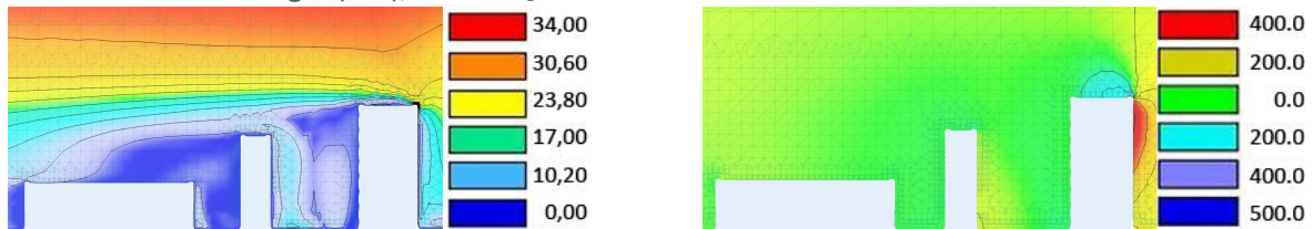
Abbildung 27: Simulationsergebnisse auf Dlubal RWind. Links die Geschwindichkeitsverteilung (in m/s) und rechts die daraus resultierenden Kräfte (in N/m 2 ) [Institut für Architekturtechnologie (IAT), TU Graz]
