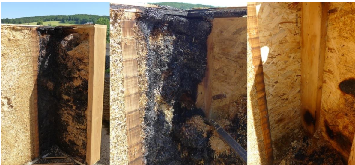
Abbildung 4-30: Geöffneter Prüfkörper mit MK46, Abtragen des verbrannten Strohs; Quelle: Eigene Aufnahmen capital [ A ] architects, DPM
