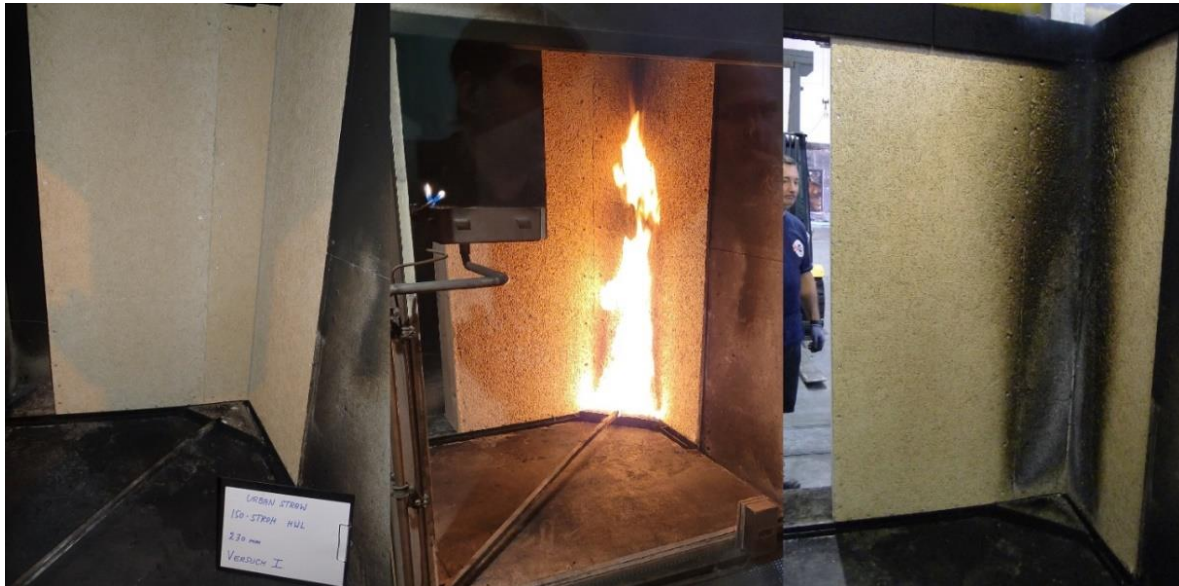
Abbildung 4-31: Prüfkörper mit HWL-Platten vor (rechts), während (mitte) und nach SBI-Test (rechts); Quelle: Eigene Aufnahmen capital [ A ] architects
