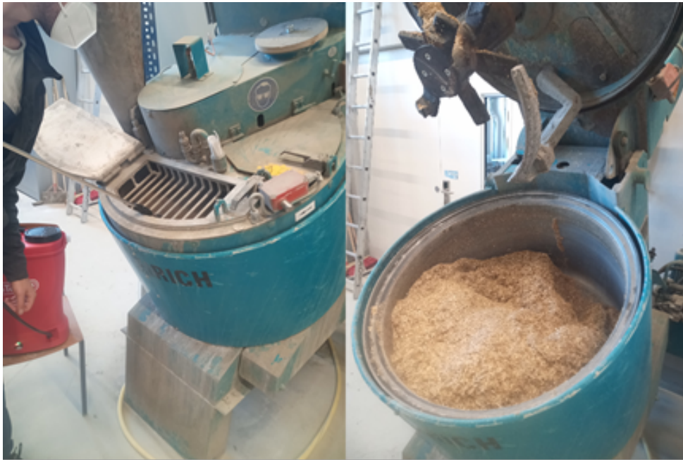
Abbildung 4-2: Einsprühen der Flammschutzmittel (links) und fertiger Materialverbund (rechts); Quelle: Eigene Aufnahmen capital [ A ] architects
