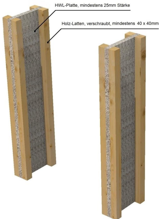
Abbildung 5-62: B-Joist Dämmständer zur Gefachteilung; Quelle: capital [ A ] architects
