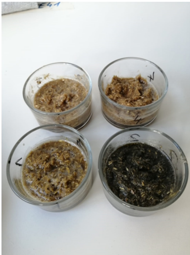
Abbildung 4-42: Fertige Proben zur pH-Wert Messung; Quelle: Eigene Aufnahmen TU Wien
