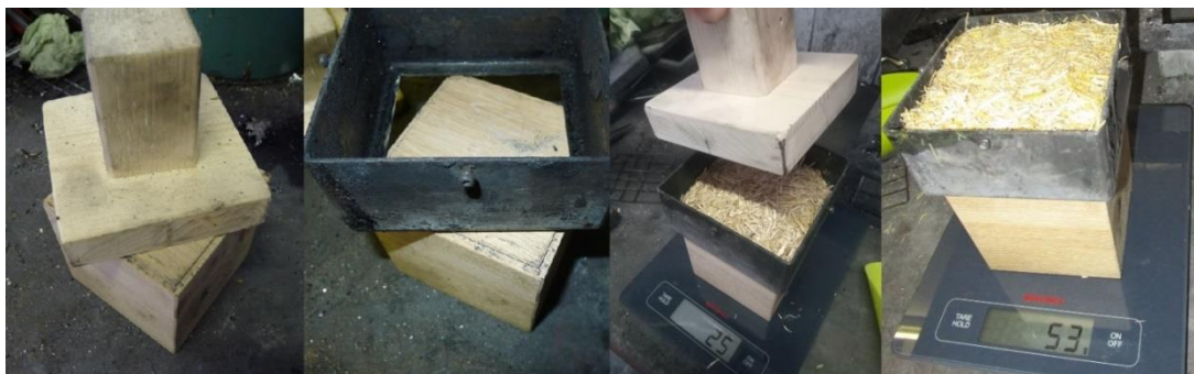
Abbildung 4-15: Herstellung der Prüfmuster; Quelle: Eigene Aufnahmen capital [ A ] architects, TGM
