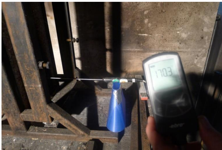
Abbildung 4-7: Temperaturmessung in der Nachglimmphase;
