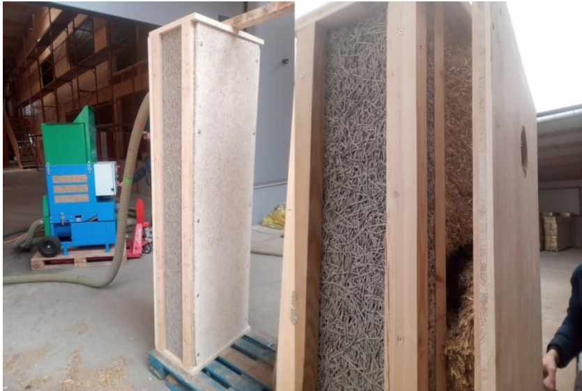
Abbildung 4-39: 2. Versuch mit HWL-Platte 15mm (links) und rückseitiges Öffnen des Wandelements nach Versuchsdurchführung (rechts);
