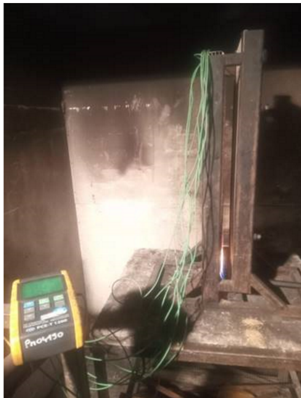
Abbildung 4-9: Anordnung der Thermosonden am Prüfkorb; Quelle: Eigene Skizze und Aufnahmen capital [ A ] architects, TGM
