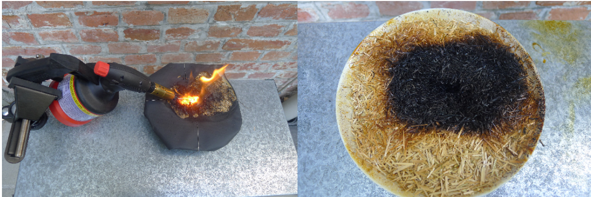
Abbildung 4-4: Brandversuch mit Lötlampe und Keramikschale (Fassadenbahn Euroklasse B); Quelle: Eigene Aufnahmen capital [ A ] architects
