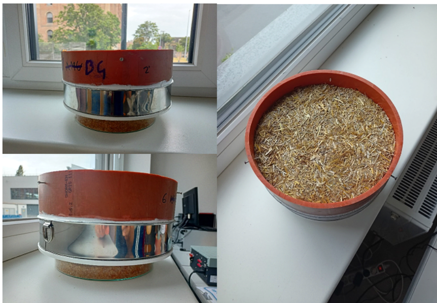
Abbildung 4-48: Von der TU-Wien hergestellter Versuchskörper nach DIN EN ISO 12572; Quelle: Eigene Aufnahmen TU Wien
