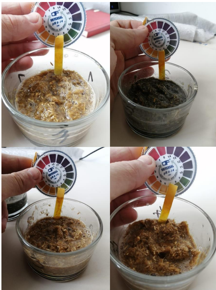
Abbildung 4-43: Indikatorstreifenergebnisse der pH-Wertmessung des behandelten Einblasstrohs; Quelle: Eigene Aufnahmen TU Wien
