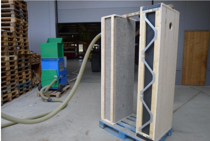
Abbildung 4-37. Versuchsaufbau mit beiden Wandelementen und einer Einblasmaschine; Quelle: Eigene Aufnahmen capital [ A ] architects, DPM
