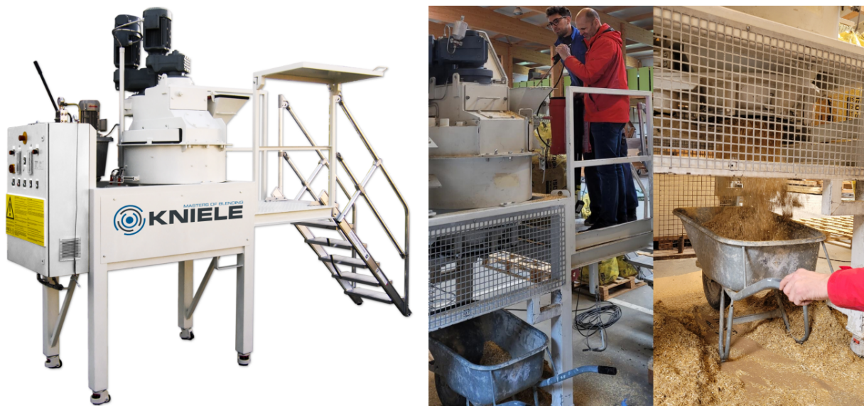
Abbildung 4-26: Mischkonditionieren von Strohhäckseln mit dem KKM Labormischer; Quelle: Kniele GmbH und eigene Aufnahmen DPM Holzdesign
