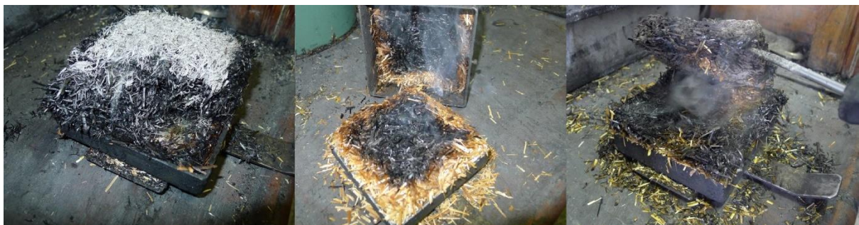
Abbildung 4-24: Proben MK46 mischkonditioniert 12 % (links), kesseldruckimprägniert (mitte) und mit HWL-Platte (rechts);
