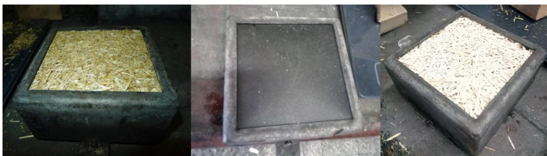
Abbildung 4-16: Prüfmuster mit Strohhäckseln (links), Folie Stamisol Safe one (mitte) und HWL-Platte (rechts); Quelle: Eigene Aufnahmen capital [ A ] architects, TGM
