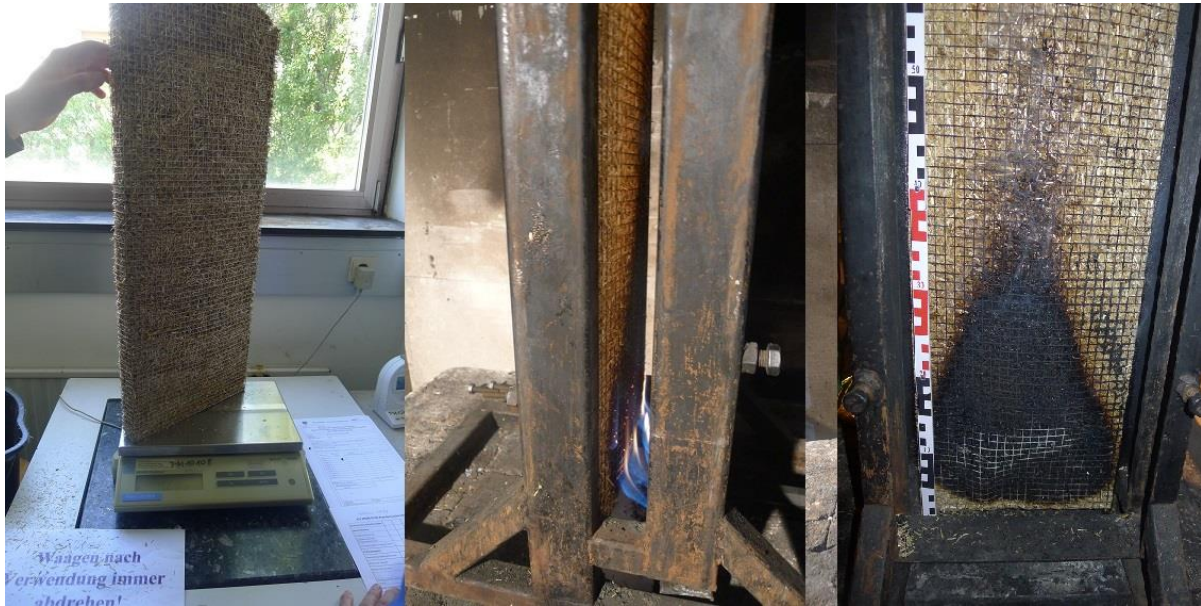
Abbildung 4-6: Abwiegen der Prüfmuster (links), Durchführung Beflammung (mitte) und Ermittlung der Abbrandhöhe (rechts);
