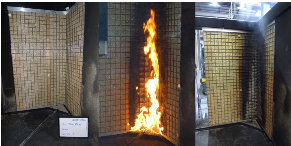
Abbildung 4-28: Prüfkörper mit MK46 vor (links), während (mitte) und nach SBI-Test (rechts); Quelle: Eigene Aufnahmen capital [ A ] architects
