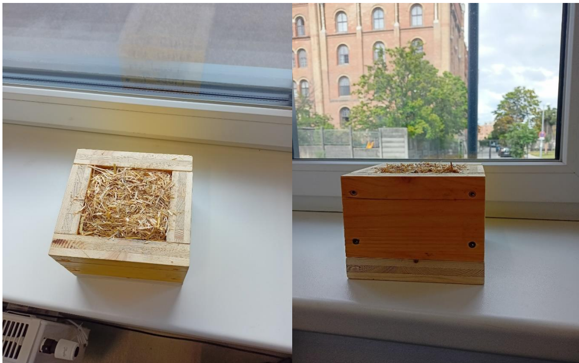
Abbildung 4-41: Versuchskörper Zur Wärmeleitfähigkeit; Quelle: Eigene Aufnahmen TU Wien
