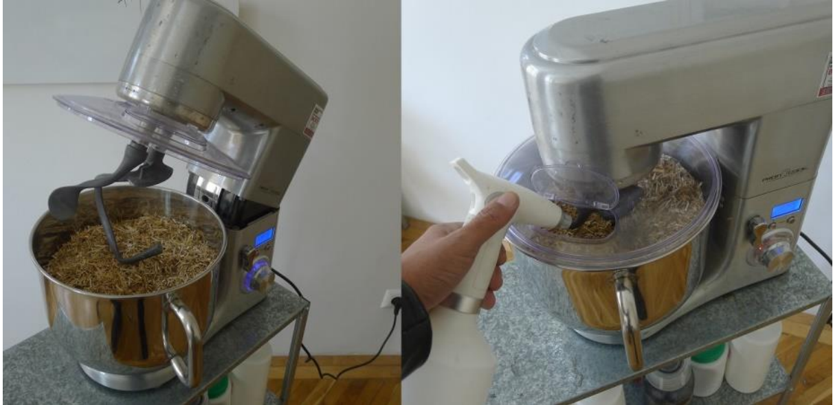
Abbildung 4-8: Herstellung Prüfmuster im Küchenknetzer, Einsprühen Flammschutzmittel; Quelle: eigene Aufnahmen capital [ A ] architects
