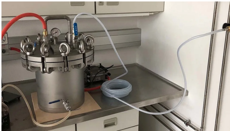
Abbildung 4-13: Kesseldruckimprägnieren im Labor-Autoklav (FH Salzburg); Quelle: FH Salzburg
