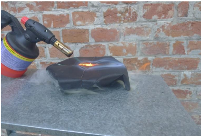
Abbildung 4-5: Versagen und Flambbildung bei der Fassadenbahn A2 Stamisol Safe one; Quelle: Eigene Aufnahmen capital [ A ] architects
