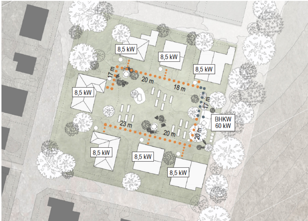
Abb. 31: Gebäudeverband mit Mini-BHKW
