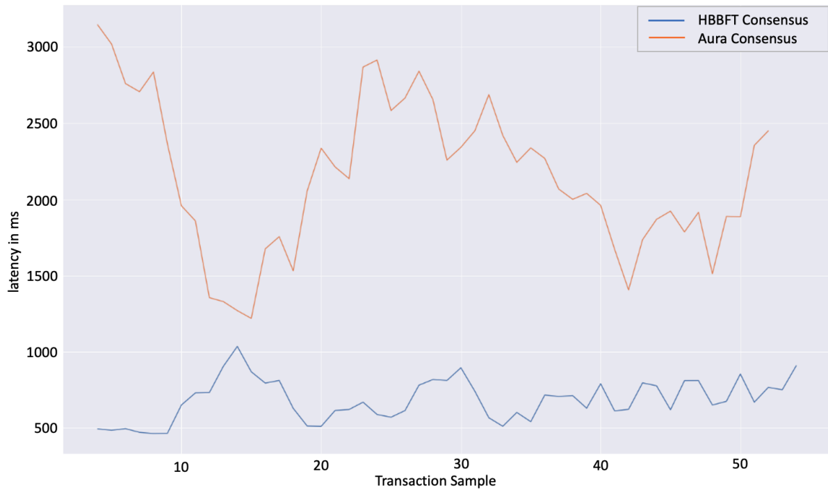
Abbildung 18: Latenzvergleich HBBFT vs. AuRa-Konsens mit Parity-Client-Software
