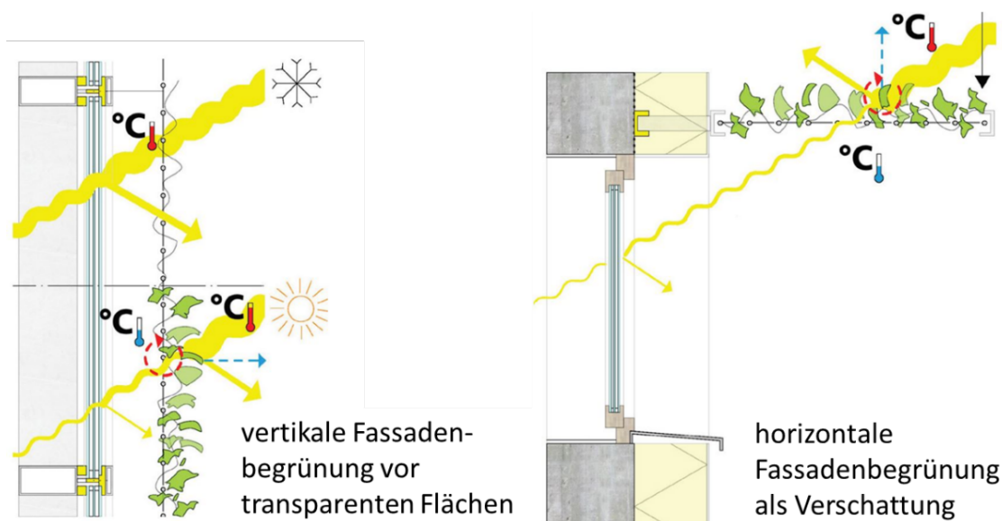
Abbildung 7: Einfluss von vertikalen und horizontalen Fassadenbegrünungen auf die solaren Wärmegewinne (Quelle: Pfoser N., 2013)
