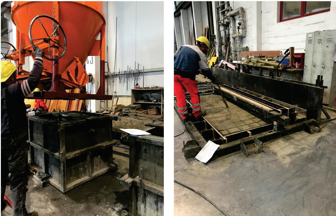
Abb. 7 Versuchsbauteile mit RCC im Mischek Systembau Fertigteilwerk Gerasdorf, e.E.
