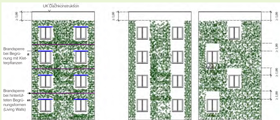
Nachweisfreie Möglichkeiten zur Montage von Fassadenbegrünungen (MA 22)
