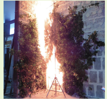
Kurzzeitige vertikale Brandweiterleitung während der Brandprüfung
