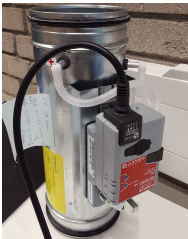
Abbildung 5: Aktiver Volumenstromregler LMV-D3-MF-F (Quelle: Fa. Pichler)
