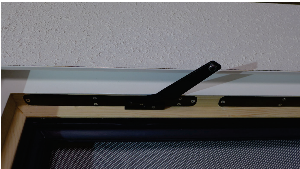
Abbildung 12: Prototyp A: Abstellmodul für Lüftungsstellung und zum Öffnen (freigeben) des Fensters (Eigenes Foto des Projektkonsortiums)
