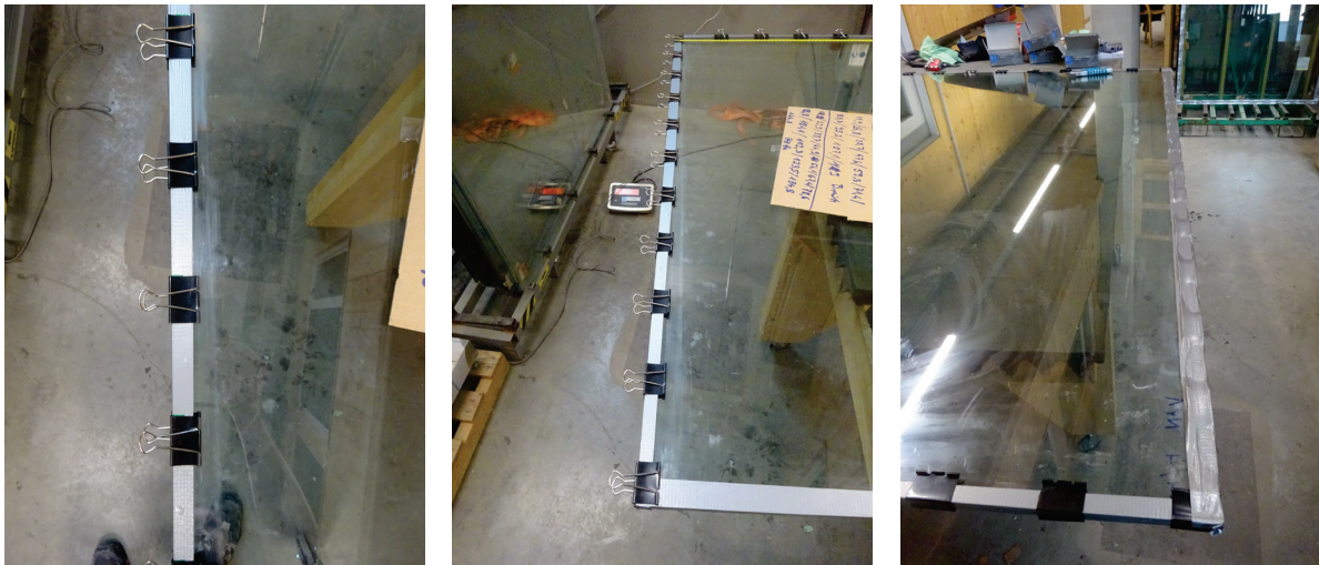
Abbildung 11: Aufbau der zusammengespannten Verglasungen (in diesem Fall 4v4+4) (Eigene Fotos HFA)
