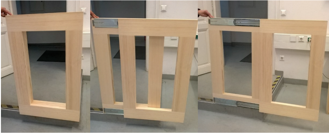
Abbildung 23: Prototyp D: Handmuster mit Teleskopschiene (geschlossen, halb offen, offen) (Eigene Fotos, Konsortium FIVA)
