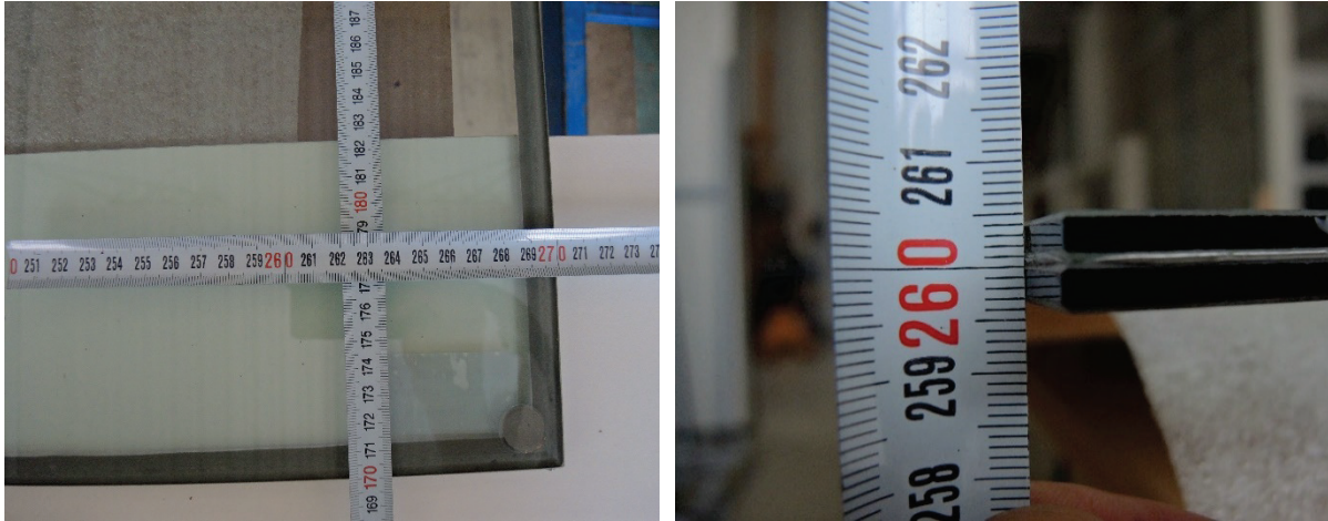
Abbildung 10: Erscheinungsform von Vakuumglas: links Vakuumglas (4v4) Draufsicht, rechts Seitenansicht (Vakuumglas on einem der untersuchten Hersteller- Hersteller 1) (Abbildung: Eigene Photographie HFA)
